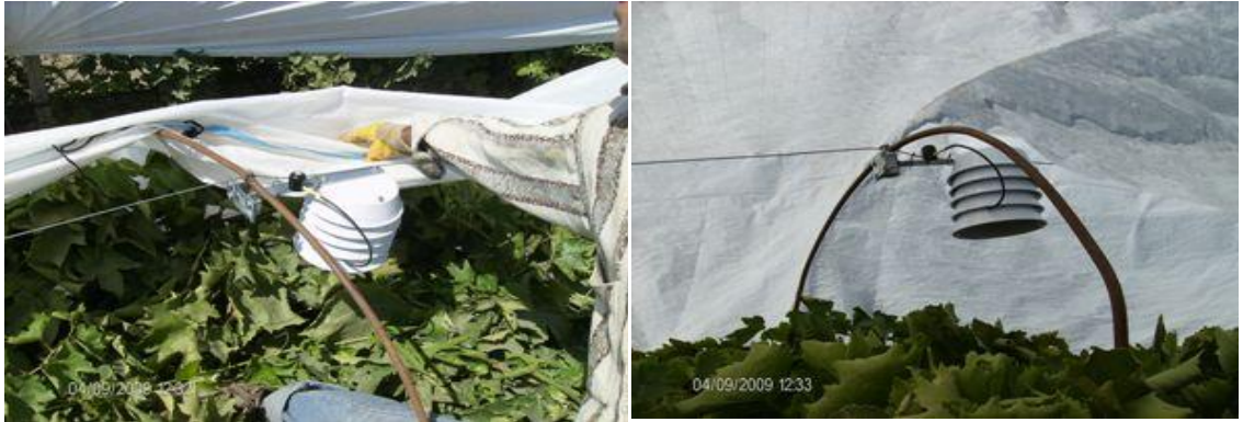
Şekil 3.8. Araştırmada asmalar üzerine yertleştirilmiş hobo (data logger) cihazı
