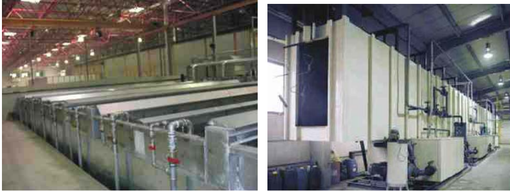
Şekil 2.3 Fosfat kaplama banyosundan genel görünüm (Yılmaz P., 2003)
