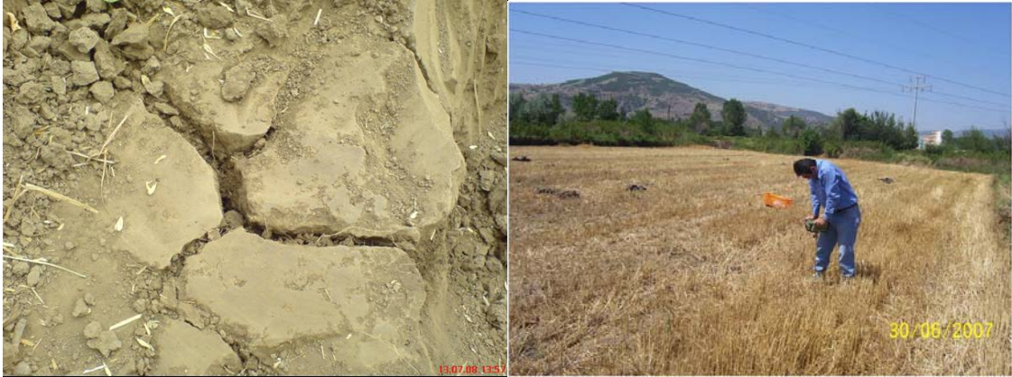
Şekil 4.2. Arazinin belirli bölgelerinde buğday hasadından sonra görülen sert katmanlar ve penetrasyon direnci ölçümleri
