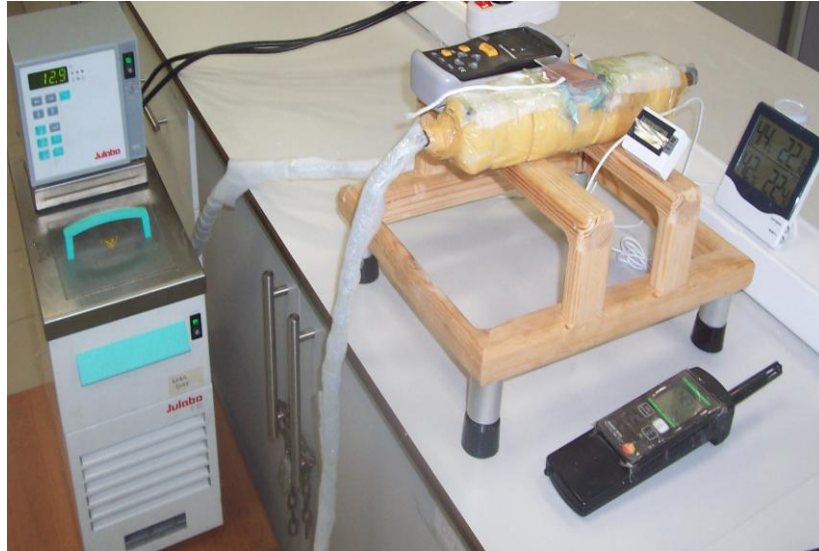
Şekil 6.5. Yoğunlaşma denemelerinin gerçekleştiği sirkülötör, bakır soğutucu ve bakır plakadan oluşan sistem.
