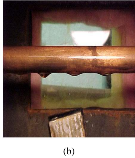
Şekil 4.9. Film tipi yoğunlaşmanın yatay bir boru yüzeyindeki (a) şematik gösterimi, (b) görüntüsü [Özler, 2007].
