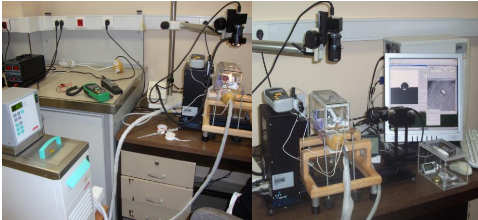
Şekil 6.10. Damla yoğunlaşması ile su damlası büyümesi denemelerinin gerçekleştirildiği sistem.
