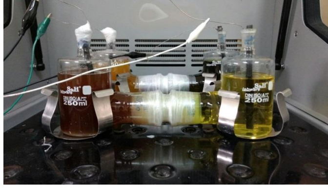
Şekil 3.3. Deneylerde kullanılmış olan mikrobiyal yakıt hücresi
