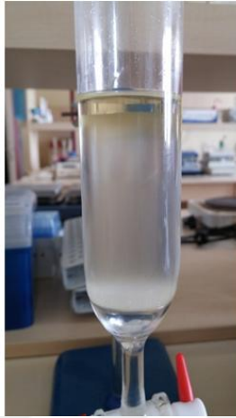
Şekil 2.8. Silika jel ile doldurulmuş, örnek yüklenmiş kolon
