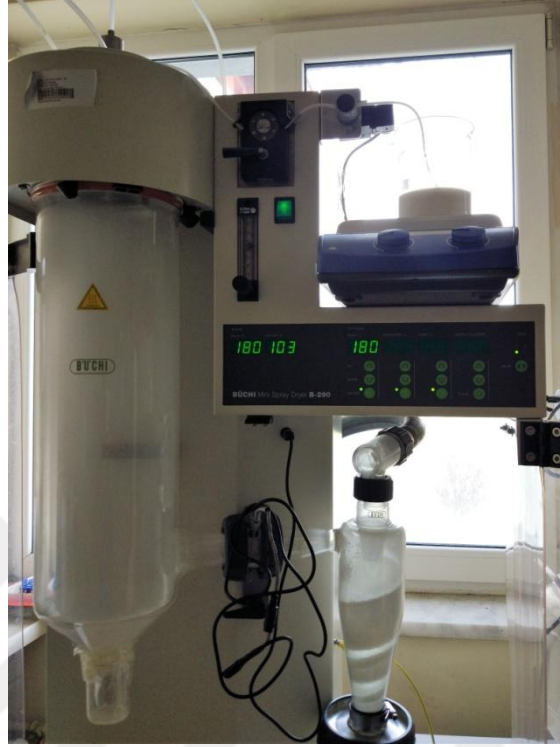
Şekil 2.11. Mikroenkapsülasyon aşaması püskürtmeli kurutma işlemi
