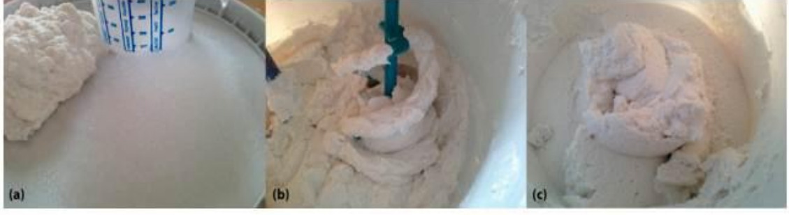
Şekil 3. 10 Sivanın üç orijinal bileşenini (tanecikli aerojel, kalsiyum hidroksit ve su) ve karışımın farklı adımlarını göstermektedir. (a) orijinal bileşenler; (b) karıştırma aşaması; (c) sıvanın son bileşimi [38]
