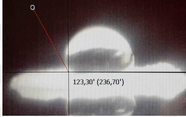
Şekil A. 50 TK-pH-5 numunesinin temas açısı ölçüm görüntüsü
