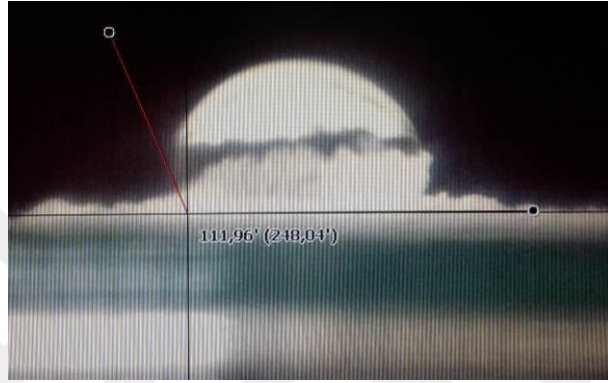
Şekil A. 4 BA-pH-9 numunesinin temas açısı ölçüm görüntüsü
