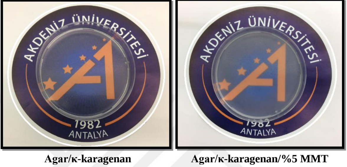
Şekil 4.47. Agar/κ-karagenan ve agar/κ-karagenan/%5 MMT hidrojenlerinin transparanlığının karşılaştırılması.
