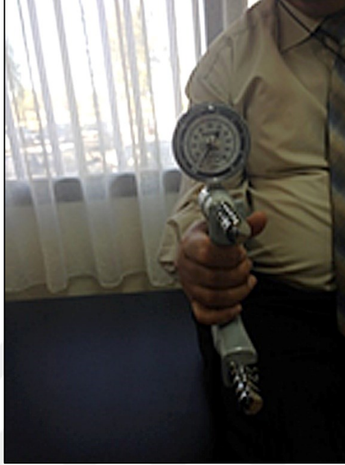
Şekil 1. Kavrama kuvvetinin ölçülmesi
