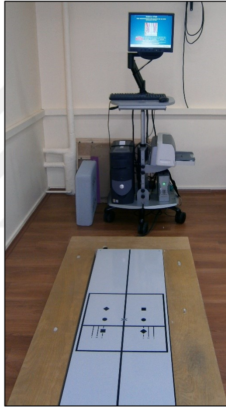
Şekil 5. Balance Master denge ölçüm ve eğitim cihazı
