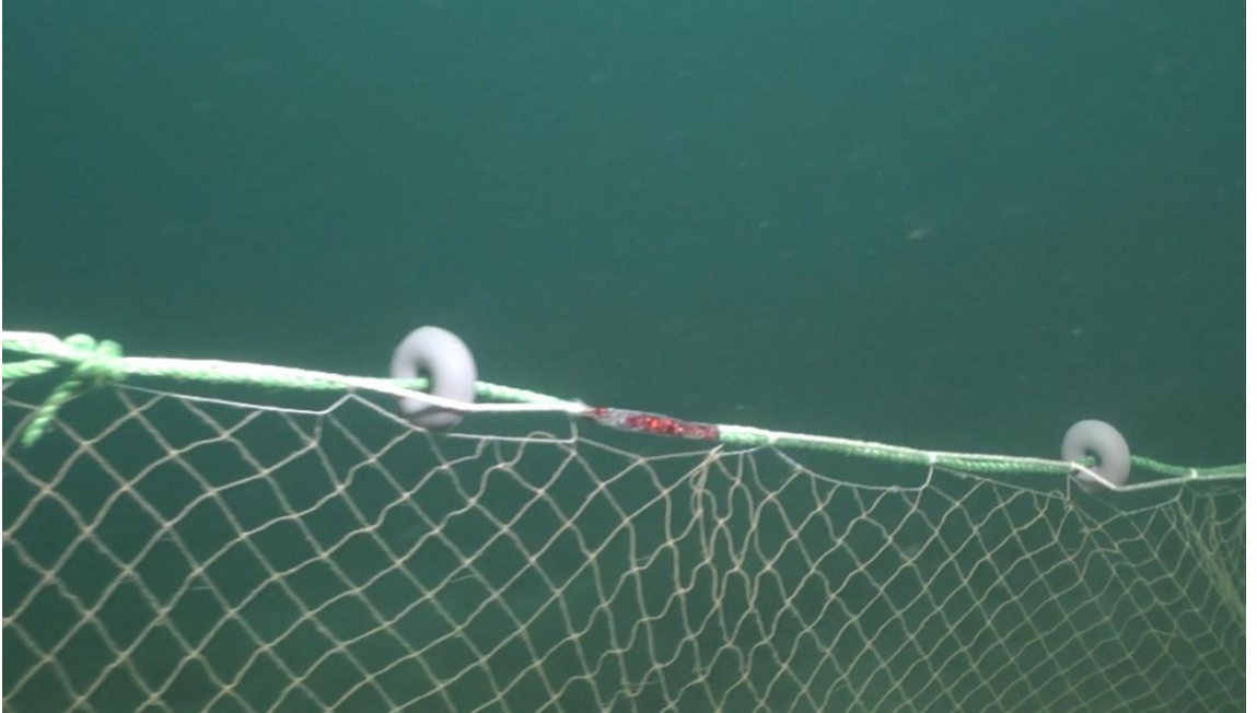
Şekil 3.4. E=0,65 Donam faktörüne sahip ağın mantar yakasının sualtındaki görünümü
