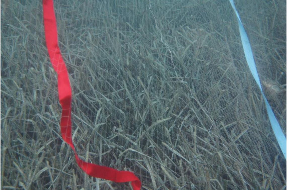
Şekil 3.6. Ağların başlangıç ve bitiş uçlarına bağlanan kurdeleler ( E=0,35 ve 0,65 donam faktöründeki ağların başlangıç ve bitiş noktaları)
