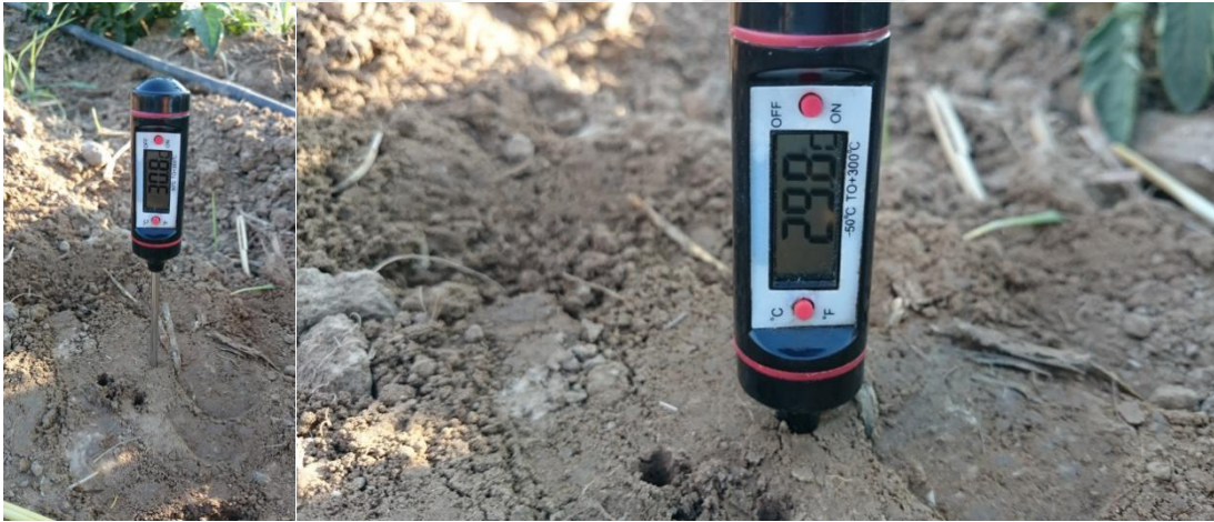
Şekil 3.2.2.1.1. Toprak sıcaklıklarının ölçüm işleminde kullanılan daldırma saplama tipi dijital sıcaklık ölçer (orijinal)
