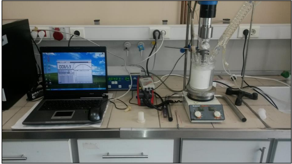
Şekil 3.8: Ultrases destekli biyodizel üretimi deney düzeneği.
