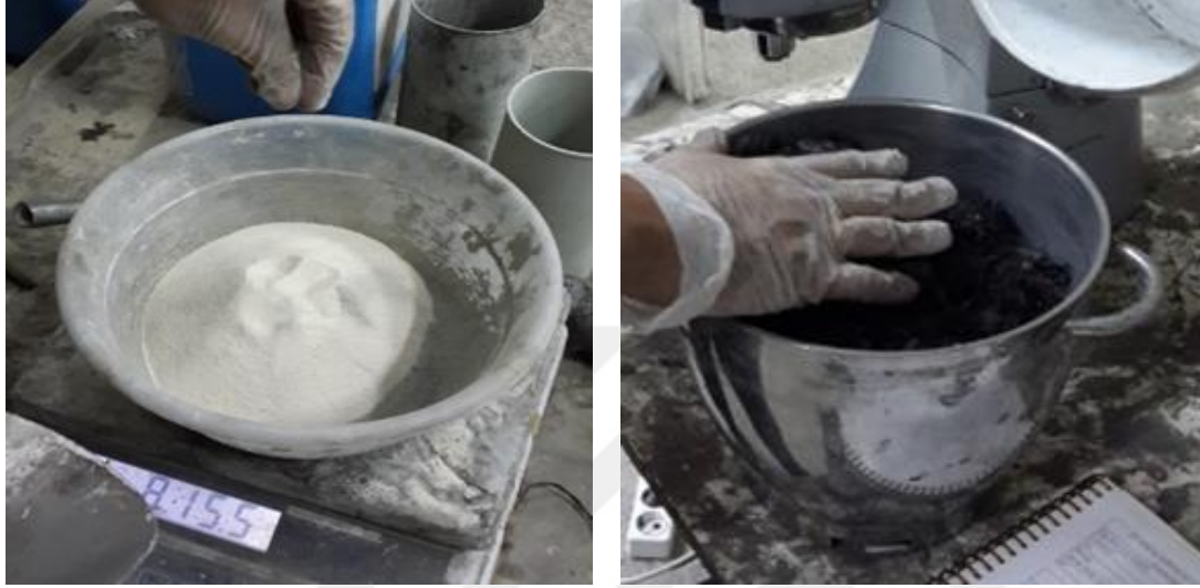
Şekil 4.7. Karbon liflerin çimento esaslı karışımlara eklenmesi
