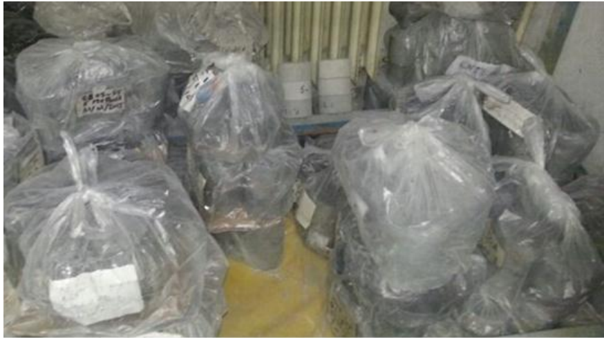
řekil 4.11. Numunelerin test srelerine kadar geirimsiz plastik pořetlerde kr edilmesi
