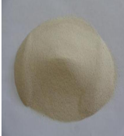
c) İnce taneli kum ve tane boyut dağılımı (lazer kırınım yöntemi)
