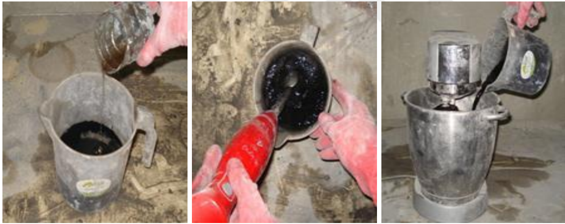
Şekil 4.6. Karbon esaslı nano malzemelerin (sırasıyla soldan sağa) çimento esaslı karışımlara eklenmesi
