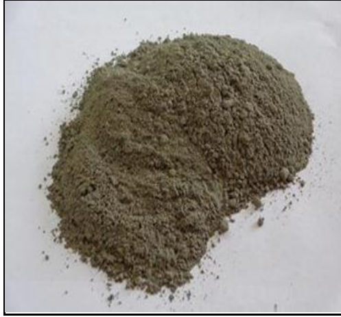
a) CEM I 42.5R Portland çimentosu ve morfolojik yapısı
