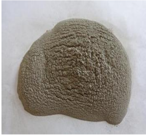
b) F sınıfı uçucu kül ve morfolojik yapısı
