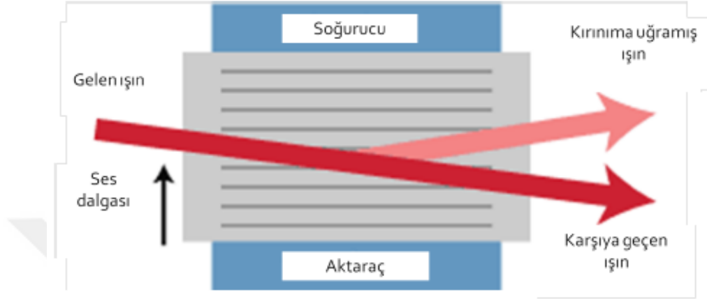
Şekil 2.13. Basit bir akusto-optik modölatör şematığı [24].
