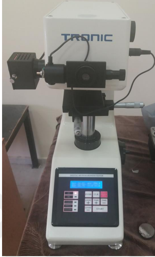
Şekil 5.4. Tronic dhv-1000 micro vickers sertlik ölçüm cihazı
