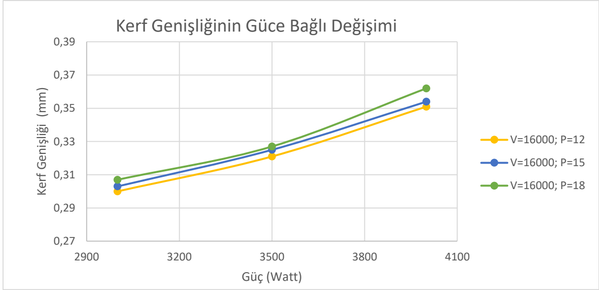
Şekil 6.14..2 V=16000 mm/dak için kerf genişliğinin güce bağlı değişimi
