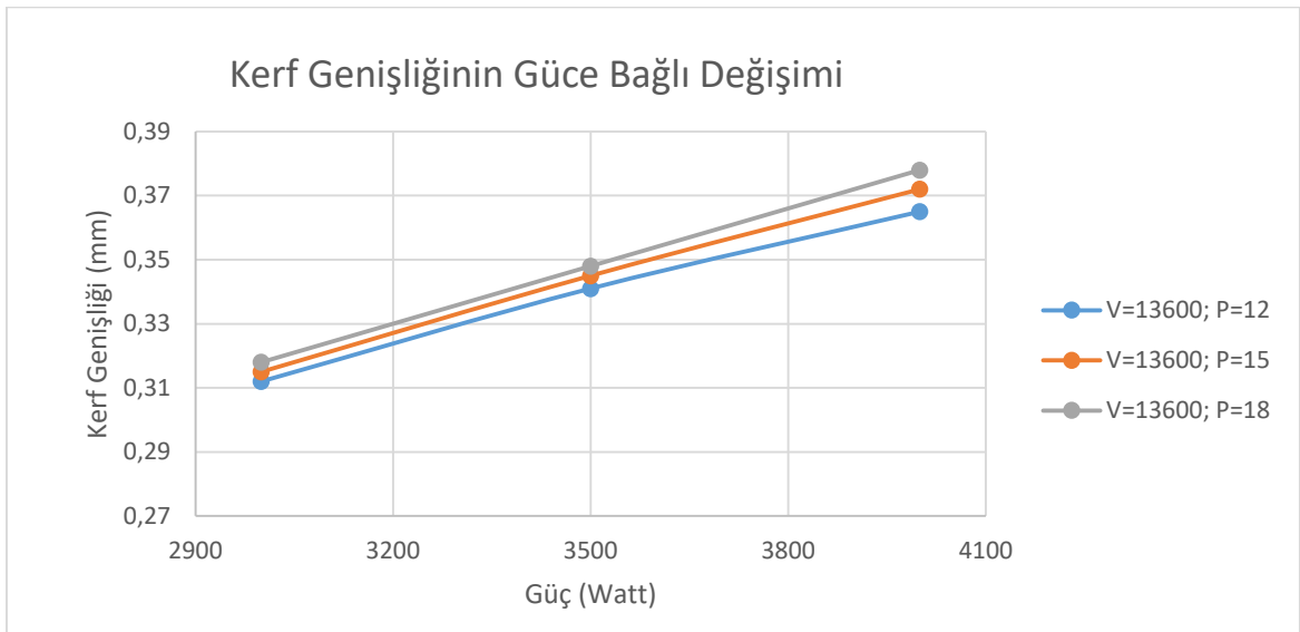
Şekil 6.14.1. V=13600 mm/dak için kerf genişliğinin güce bağlı değişimi
