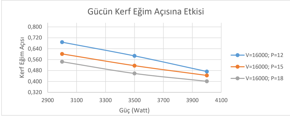
Şekil 6.17.2.2. V=16000 mm/dak için kerf eğim açısının güce bağlı değişimi
