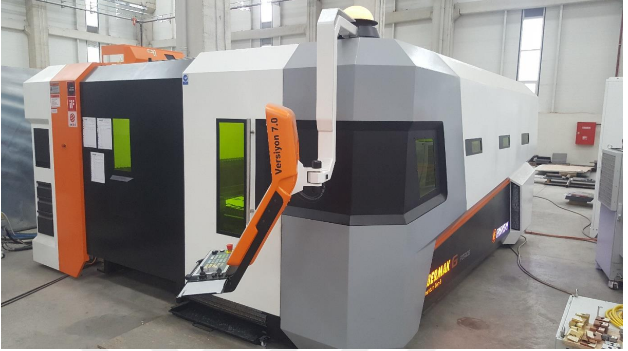
Şekil 5.2. Deneyde kullanılan fiber lazer kesim tezgahı
