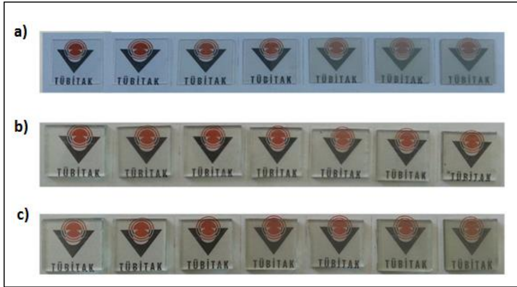
Şekil 4.18: a) APTES-AgNWs (PVP), b) MP TES-AgNWs (PVP), c) APTES-AgNWs (COOH) tek katmanlı filmlerin 1.5, 3, 6, 9, 12, 18, 24 h kaplama süreleri için makro görüntüleri.
