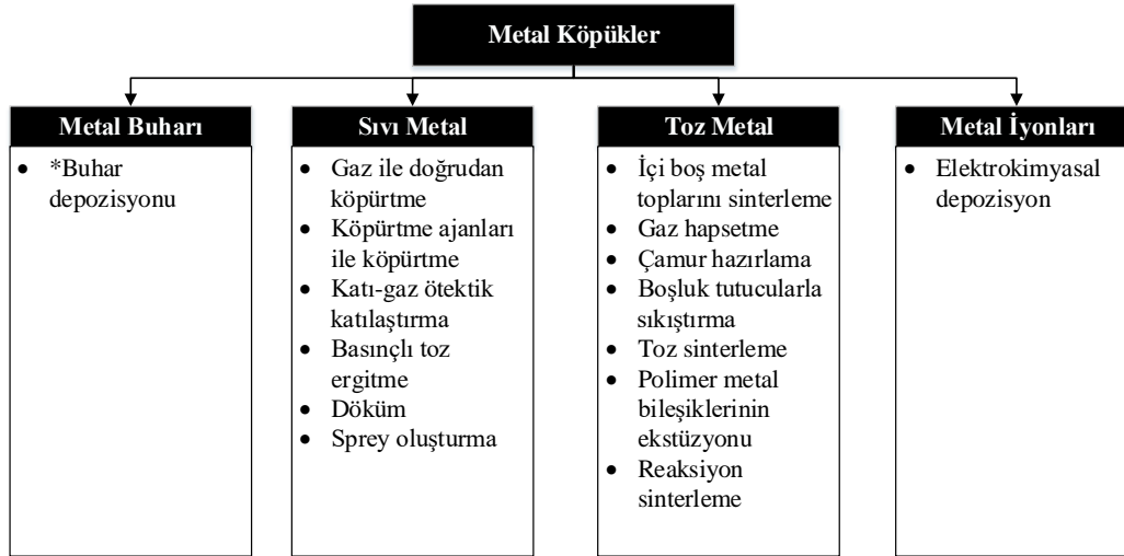
Şekil 2.4 : Metal köpüklerin üretim yöntemleri [19].
