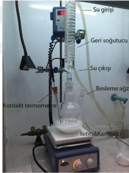
Şekil 4.1. Kalsiyum borat sentezi için deney düzeneği
