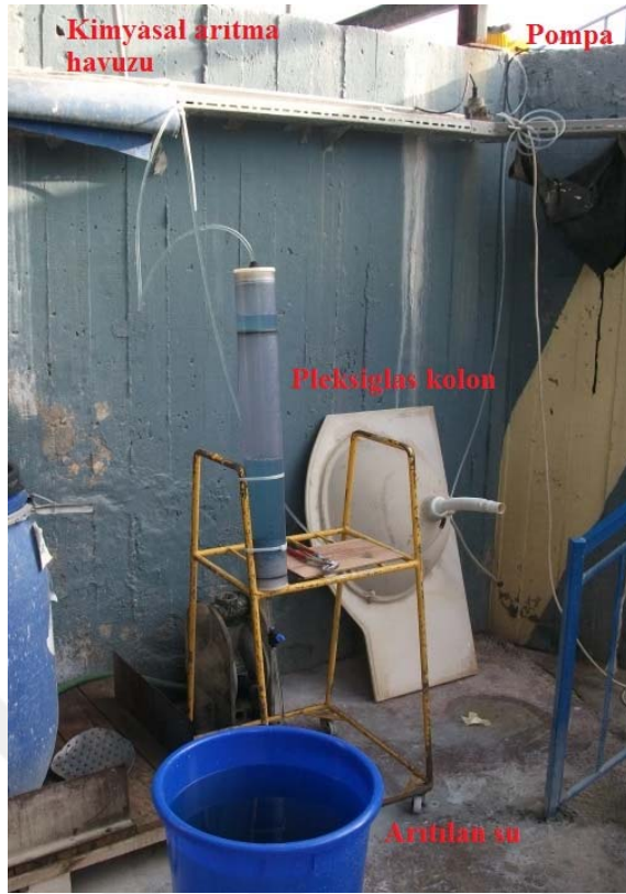
Şekil 9.9 Büyük ölçekte yapılan adsorpsiyon deneyi sisteminin görüntüsü
