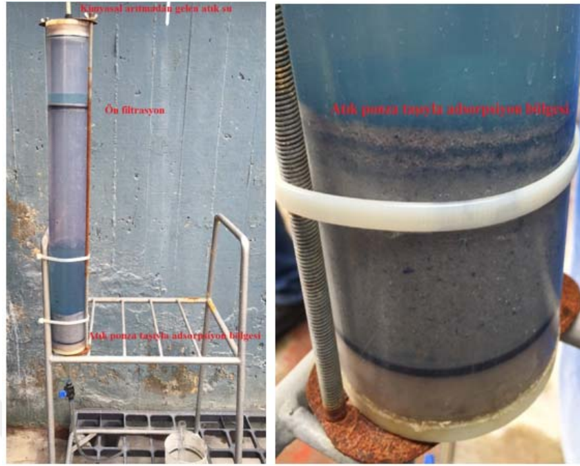
Şekil 9.14 Atık pumza taşının kimyasal arıtma çıkış suyu üzerindeki adsorpsiyonu deneyi
