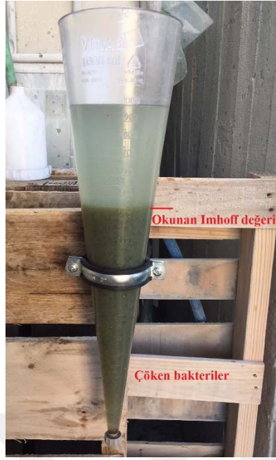
Şekil 9.15 Imhoff hunisi ve tasarlanan biyolojik arıtma sistemindeki bakterilerin miktarı
