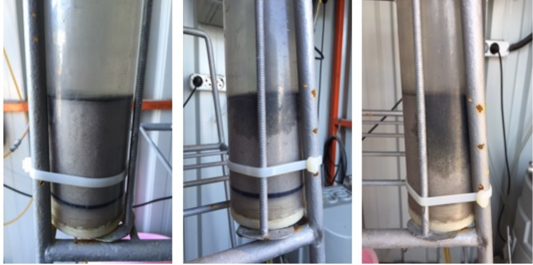
Şekil 9.21 Ponza taşıyla biyolojik arıtma çıkış suyu üzerinde adsorpsiyon denemesi
