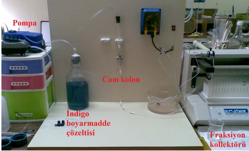
Şekil 9.4 İndigo boyarmaddenin sulu çözeltisinin, atık ponza taşlarıyla adsorpsiyona uğradığı sistem
