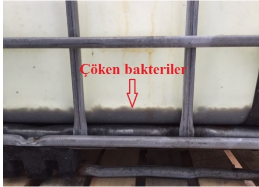
Şekil 9.16 Tasarlanan biyolojik arıtma sonrası çöken bakterilerin görüntüsü
