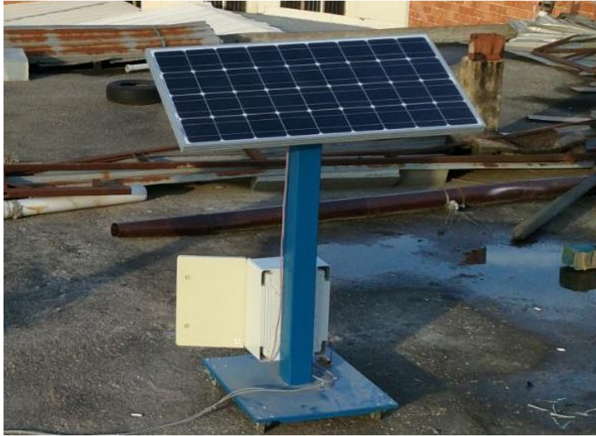
Şekil 4.1. En uygun yıllık eğim açısı ile konumlandırılmış sabit güneş sistemi
