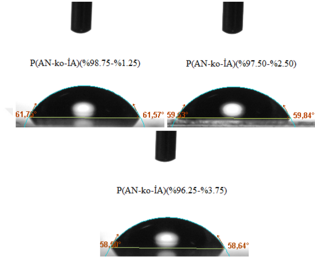
Şekil 4.23. P(AN-ko-İA) kopolimerlerinin temas açısı görüntüleri
