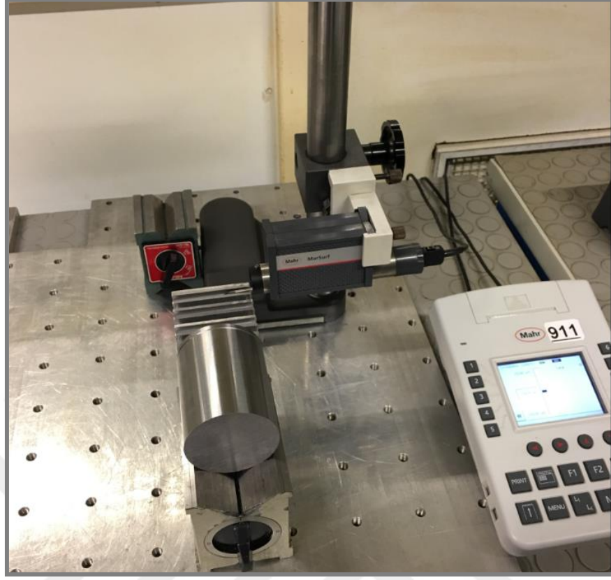
Şekil 6.10. MAHR-Perthometer-M1 taşınabilir yüzey pürüzlülük ölçüm cihazı.
