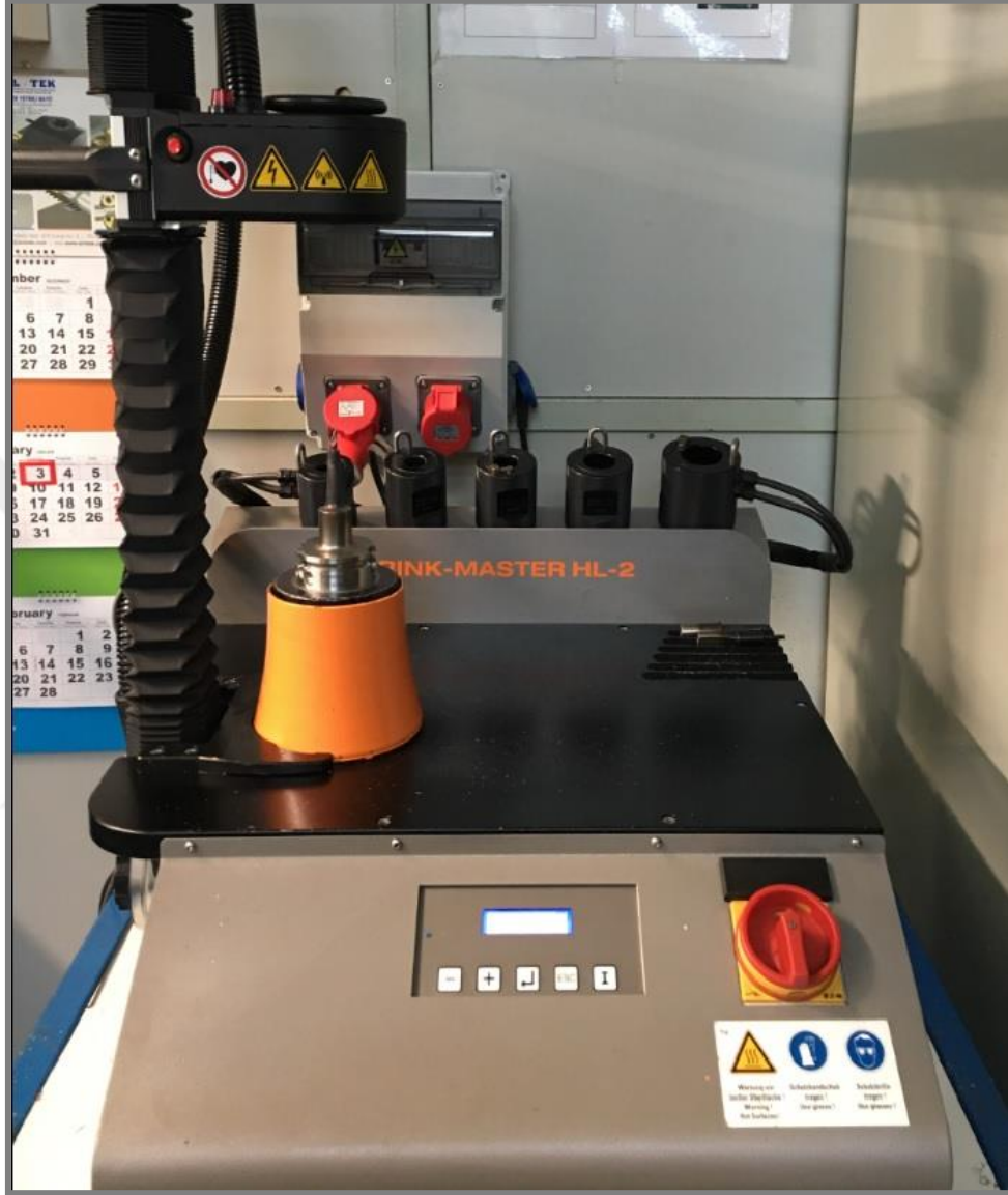
Şekil 6.4. Emuge marka otomatik ısıtarak takma sökme (shrink) makinesi ve takım tutucu.
