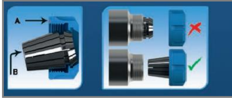
Şekil 3.7. Pensin kapağa doğru şekilde bağlanmasının teorik gösterimi.
