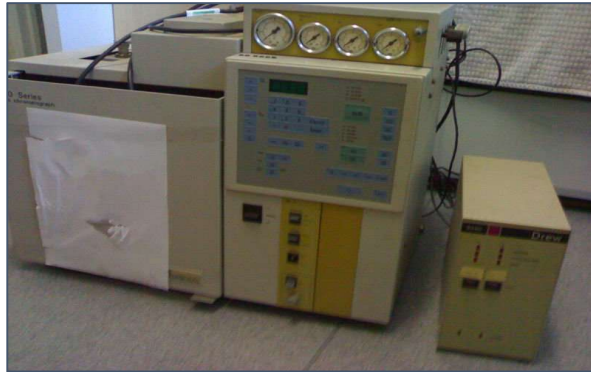
Şekil 2.1. Kullanılan ATI Unicam 610 model gaz kromatograf sistemi.
