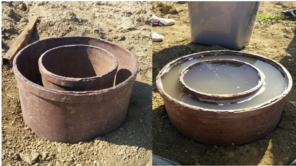
Şekil 3.13. Su alma hızı ölçümü
