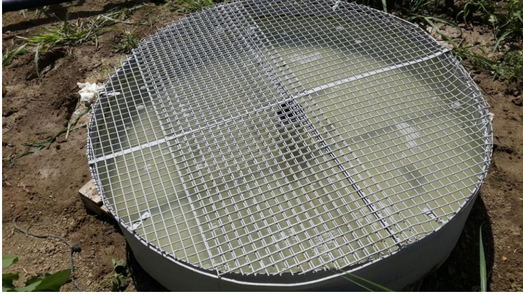
Şekil 3.6. Deneme alanında kullanılan A sınıfı buharlaşma kabı
