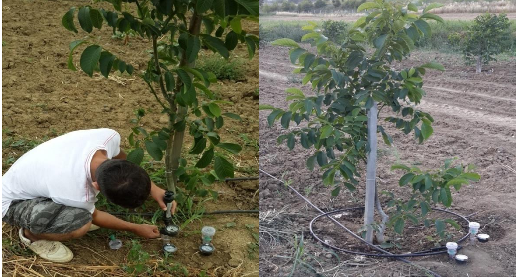
Şekil 3.14. Denemede kullanılan tansiyometreler
