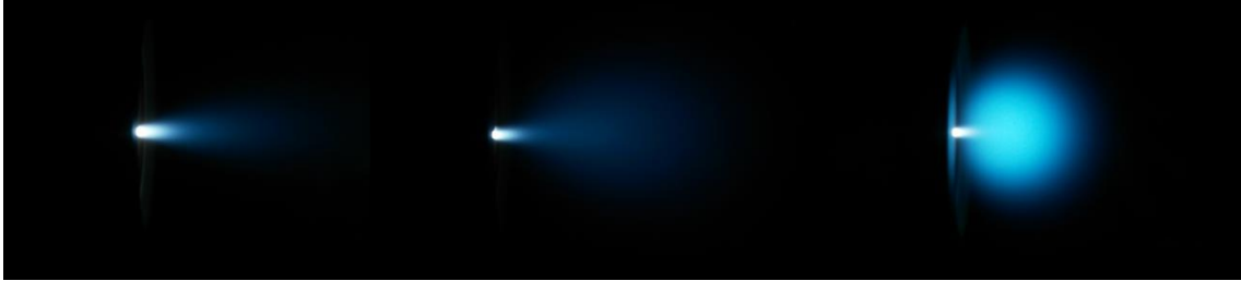
Şekil 3.4. Çinko Oksit (ZnO) hedef malzemesinin ablasyonu sonucu oluşan plazmanın artan oksijen gaz basıncı içindeki yayılımı
