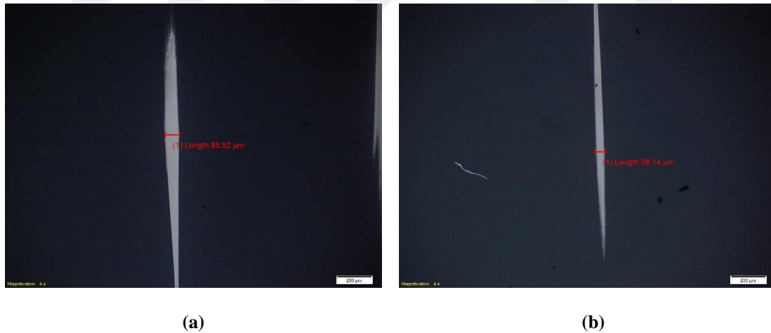
Şekil 4.1. D-scan ablasyon profilinde ortaya çıkan simetri bozulması a) uygun, b) kusurlu profil kanadı
