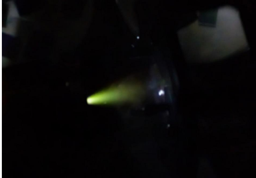
Şekil 3.3. PLD vakum odasında oluşan plazma genişleyen bir şekilde hedef malzemedan uzaklaşmaktadır
