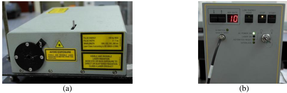
Şekil 3.8. Minilite II lazer sistemi a) Lazerin üretildiği ünite b) Güç ve kontrol ünitesi
