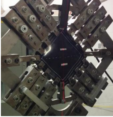
Resim 5.4. İki eksenli çekme testi düzeneği
