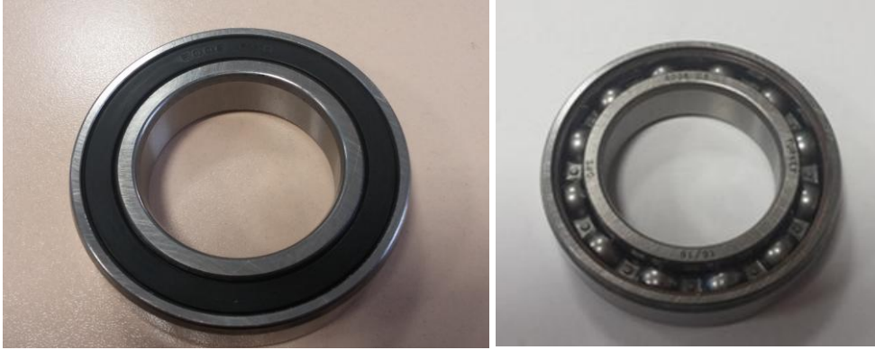
Resim 4.2. Testlerde kullanılan NBR kapaklı ve kapaksız (açık) 6008 rulmanı
