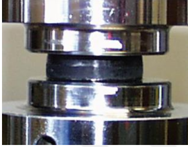
Resim 5.5. Tek eksenli basma testi [38]
