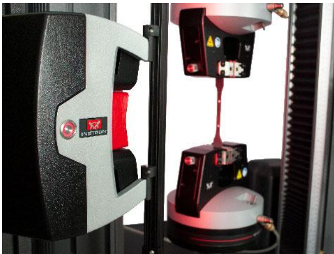
Resim 5.2. Tek eksenli çekme testi tezgahı [35]
