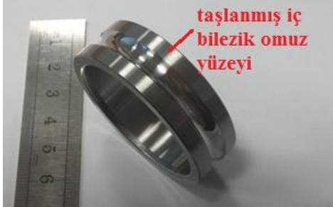
Resim 4.7. 6008 iç bilezik taşlanmış omuz yüzeyi
