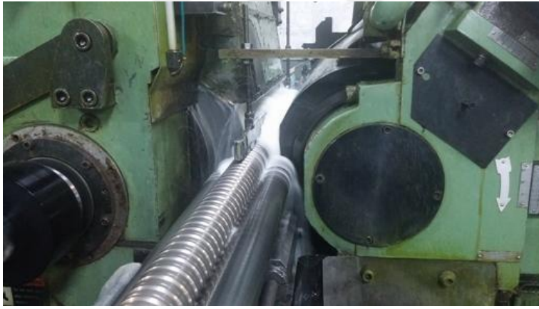
Resim 4.3. Puntasız taşlama tezgahında iç bileziklerin omuz taşlama işlemi
