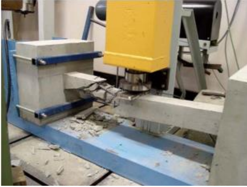
Resim 1.1. Yük etkidikten sonra kolonda oluşan deformasyon
