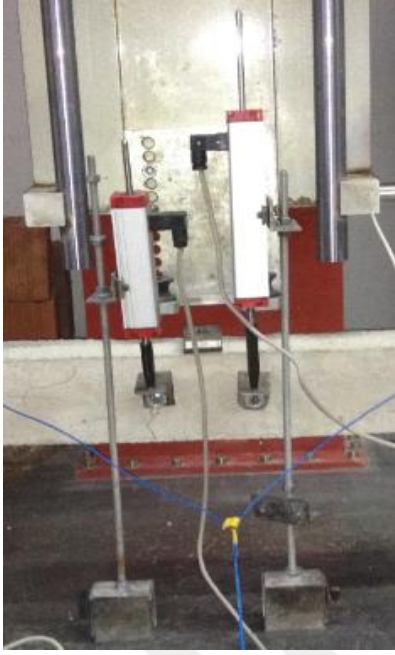
Resim 2.8. Deneyde kullanılan LVDT
