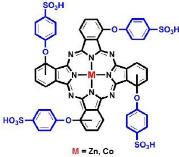
Şekil 2.12: Tetra non-periferal p-sülfonilfenoksi süstitüe Zn(II) ve Co(II) ftalosiyanimler.
