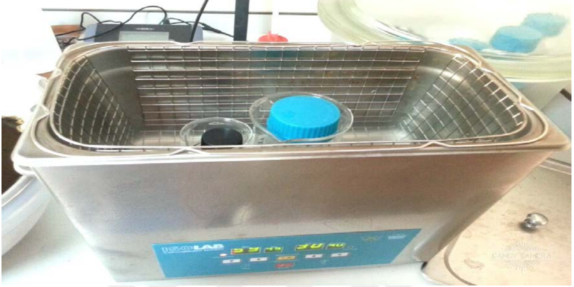
Şekil 2.1. Ultrasonik temizleme cihazı
