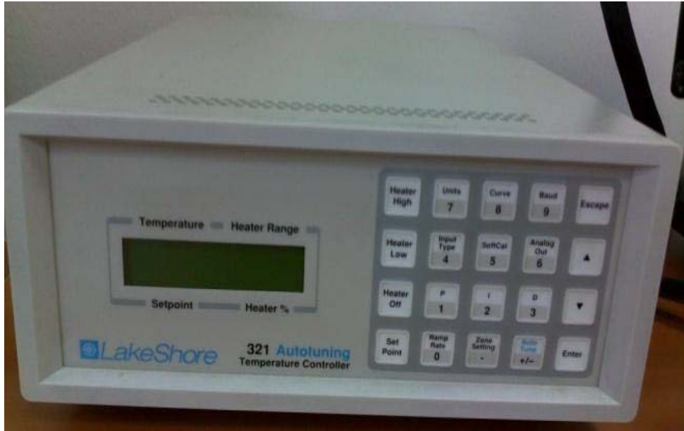
Şekil 2.7. Lake Shore model 321 sıcaklık kontrol sistemi
