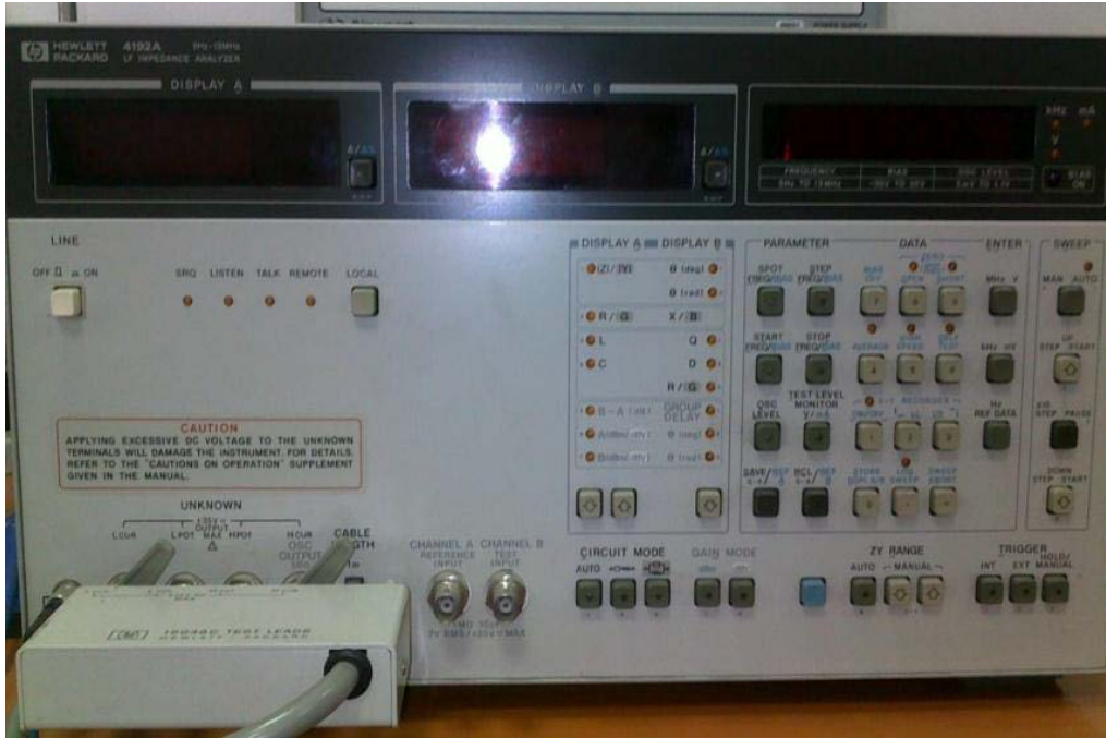
Şekil 2.5. HP 4192 LF empedans analizörü
