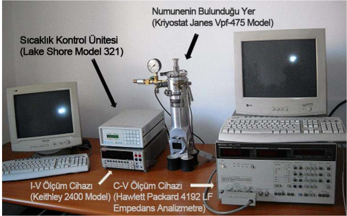
Şekil 2.8. Deneysel ölçüm sisteminin fotoğrafın görünümü
