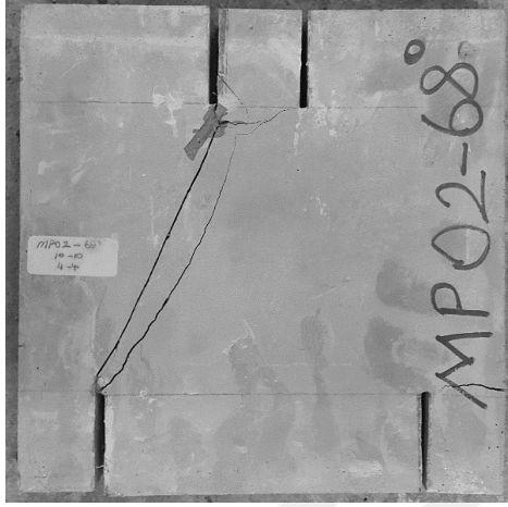
Resim 7.4. MP02-68 numunesinde çatlak yörüngesi
