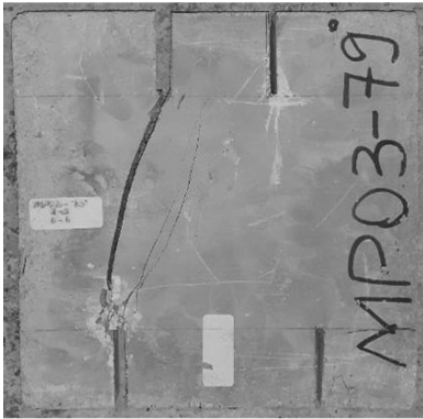
Resim 7.19. MP03-79 numunesinde çatlak yörüngesi
