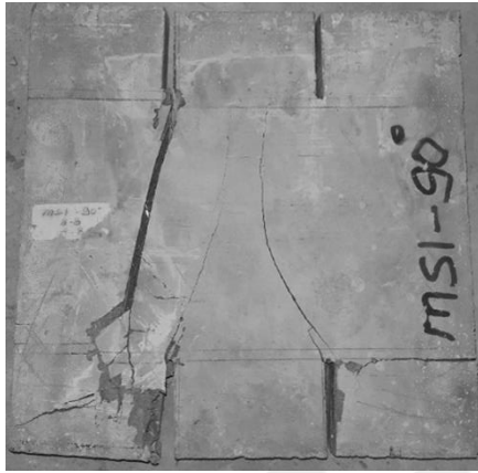
Resim 7.34. MS1-90 numunesinde çatlak yörüngesi
