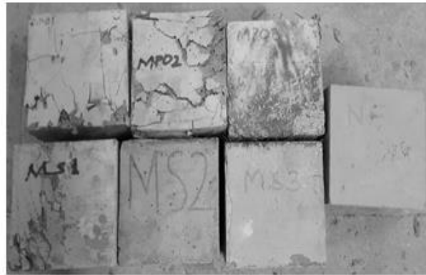
Resim 7.1. 2000 kN kapasiteli hidrolik yükleme cihazı ve kırılan küp numuneler
