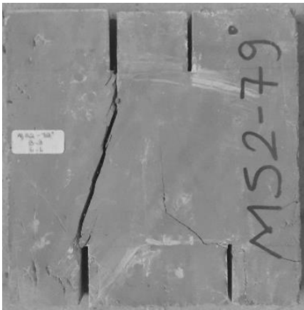
Resim 7.21. MS2-79 numunesinde çatlak yörüngesi
