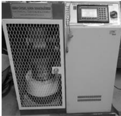
Resim 7.1. 2000 kN kapasiteli hidrolik yükleme cihazı ve kırılan küp numuneler
