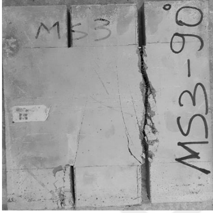
Resim 7.36. MS3-90 numunesinde çatlak yörüngesi
