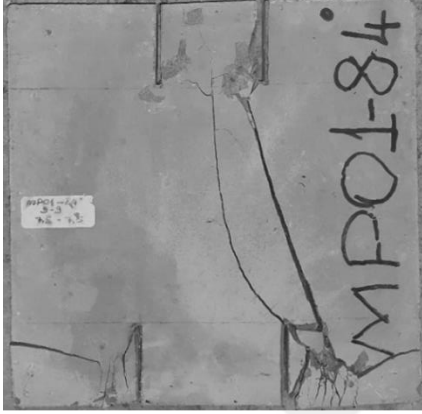
Resim 7.24. MP01-84 numunesinde çatlak yörüngesi
