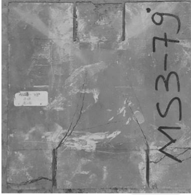
Resim 7.22. MS3-79 numunesinde çatlak yörüngesi
