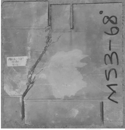
Resim 7.8. MS3-68 numunesinde çatlak yörüngesi
