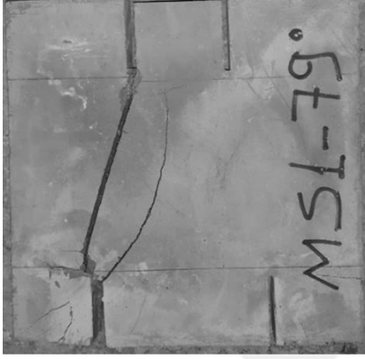
Resim 7.20. MS1-79 numunesinde çatlak yörüngesi
