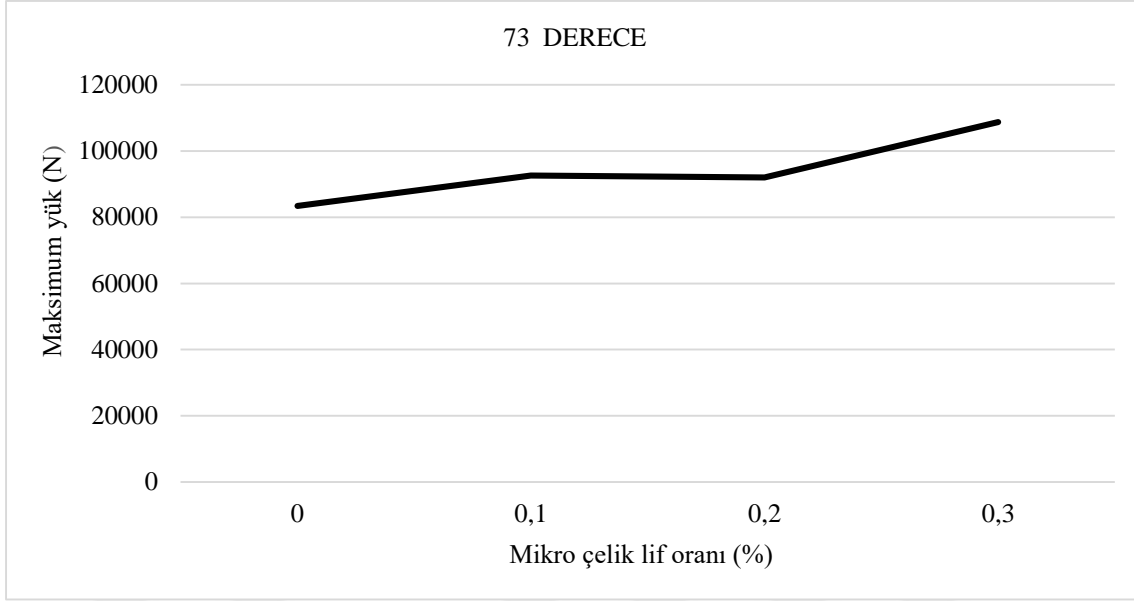
Şekil 7.85. 73° ile kırılan numuneler için mikro çelik lif oranına göre maksimum kesme kuvvetlerinin karşılaştırılması
