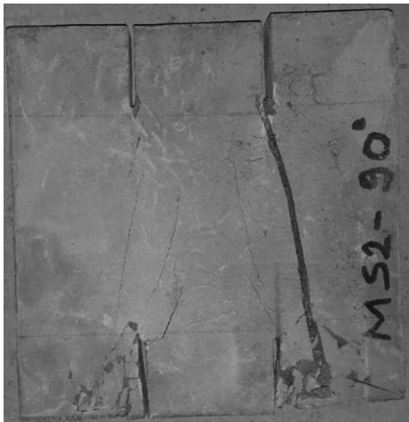
Resim 7.35. MS2-90 numunesinde çatlak yörüngesi
