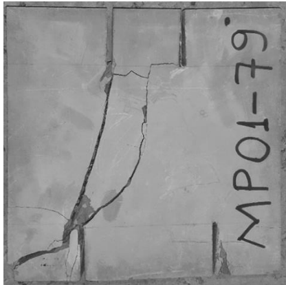
Resim 7.17. MP01-79 numunesinde çatlak yörüngesi
