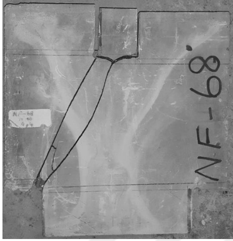
Resim 7.2. NF-68 numunesinde çatlak yörüngesi
