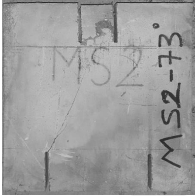
Resim 7.14. MS2-73 numunesinde çatlak yörüngesi
