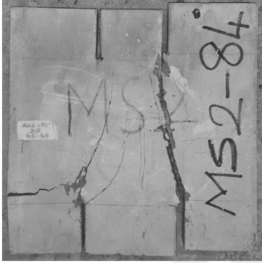
Resim 7.28. MS2-84 numunesinde çatlak yörüngesi
