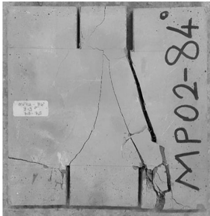
Resim 7.25. MP02-84 numunesinde çatlak yörüngesi
