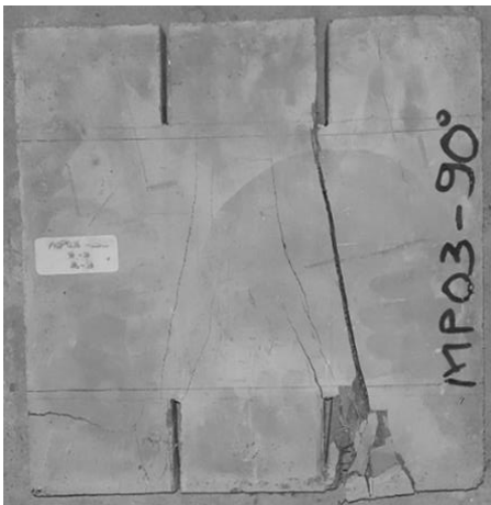
Resim 7.33. MP03-90 numunesinde çatlak yörüngesi
