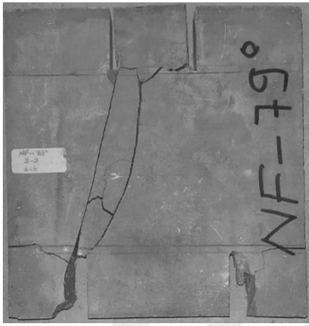
Resim 7.16. NF-79 numunesinde çatlak yörüngesi
