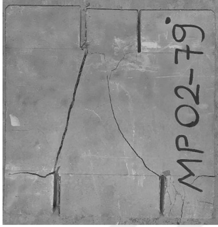
Resim 7.18. MP02-79 numunesinde çatlak yörüngesi
