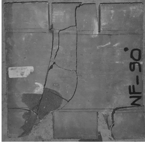
Resim 7.30. NF-90 numunesinde çatlak yörüngesi
