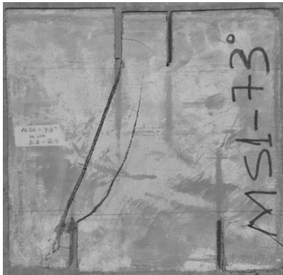
Resim 7.13. MS1-73 numunesinde çatlak yörüngesi
