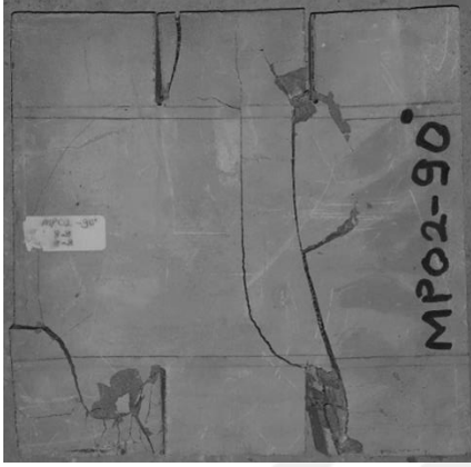
Resim 7.32. MP02-90 numunesinde çatlak yörüngesi
