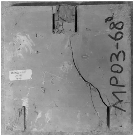
Resim 7.5. MP03-68 numunesinde çatlak yörüngesi
