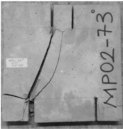
Resim 7.11. MP02-73 numunesinde çatlak yörüngesi
