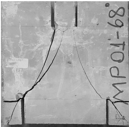
Resim 7.3. MP01-68 numunesinde çatlak yörüngesi
