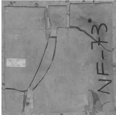
Resim 7.9. NF-73 numunesinde çatlak yörüngesi
