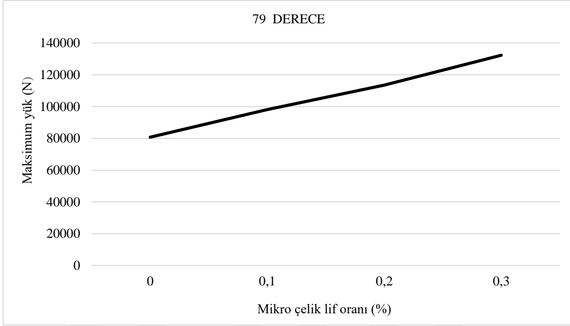
Şekil 7.92. 79° ile kırılan numuneler için mikro çelik lif oranına göre maksimum kesme kuvvetlerinin karşılaştırılması
