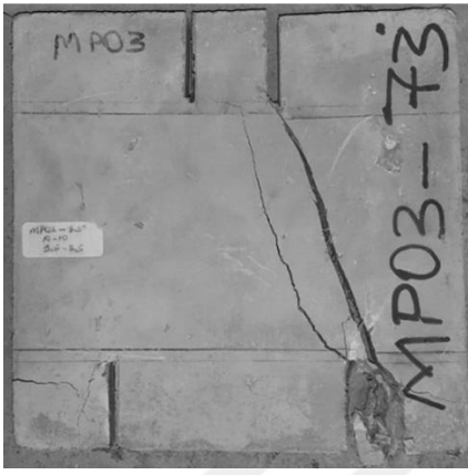
Resim 7.12. MP03-73 numunesinde çatlak yörüngesi
