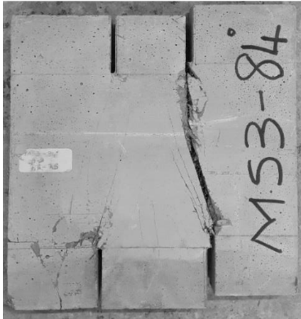
Resim 7.29. MS3-84 numunesinde çatlak yörüngesi
