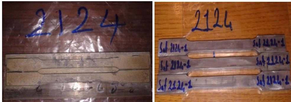
Şekil 2.12. AA2124 takviyesiz çekme numunesi a) tel erozyon makinesinde kesilmiş görüntüsü b) Numunenin zımparalanmış görüntüsü
