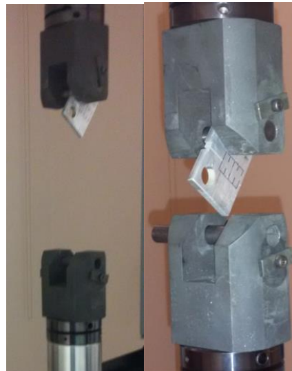
Şekil 2.19. CT yorulma numunesinin cihaz çenelerine bağlanması
