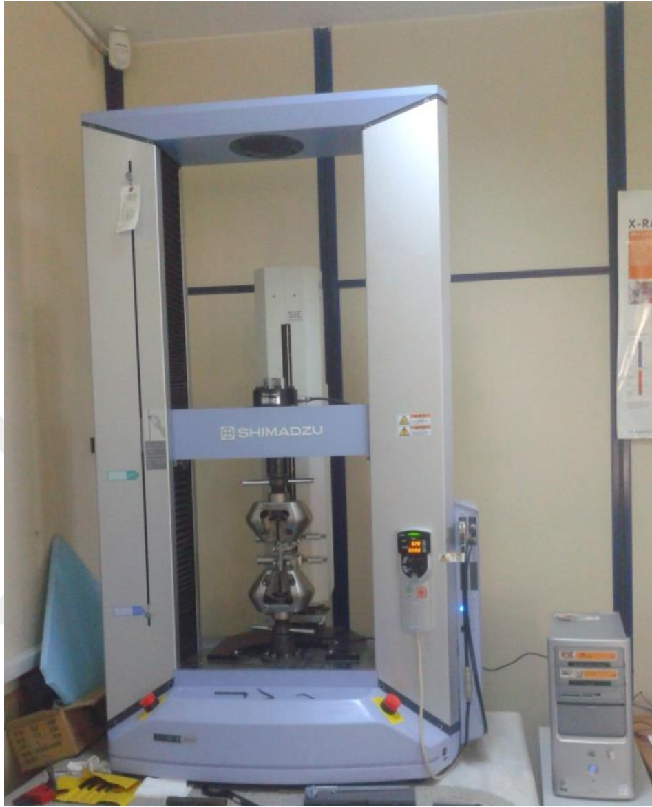
Şekil 2.16. Çekme cihazı, çekme numunesi ve ekstensometre
