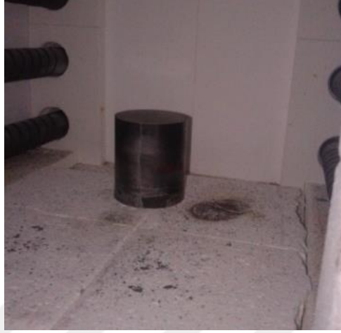
Şekil 2.8. 2124 Al bilet numunesinin fırında ısıtılması
