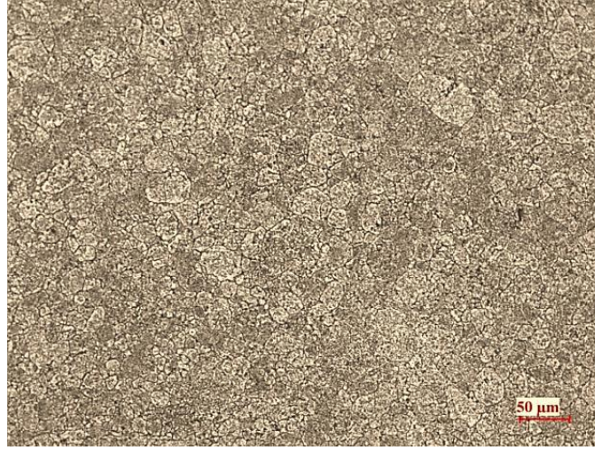
Şekil 3.18: 2124 Al alaşımlı takviyesiz 20x büyütmedeki dağlanmış bilet görüntüsü
