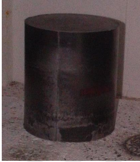
Şekil 2.5. Toz metalürjisi yöntemi ile üretilen lan AA2124 bilet
