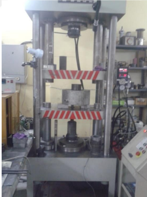
Şekil 2.9. Hidrolik pres makinesine ısıtıcı kovan, kalıp, kalıp taşıyıcının yerleştirilmesi
