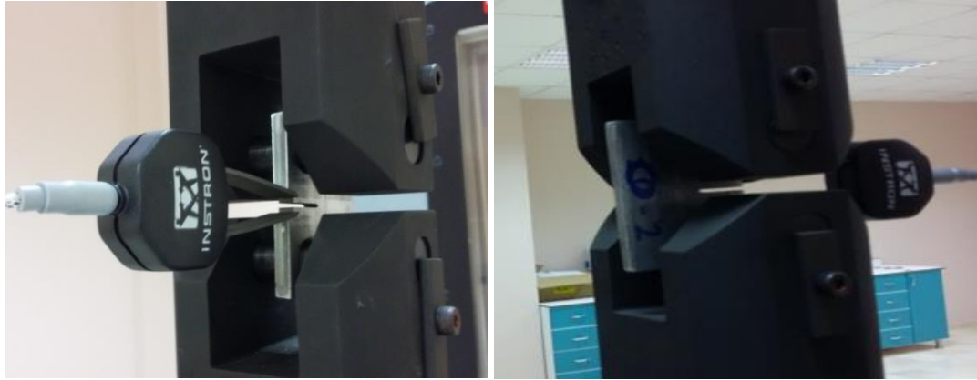
Şekil 2.20. Extansometrenin yorulma numunesine bağlanması
