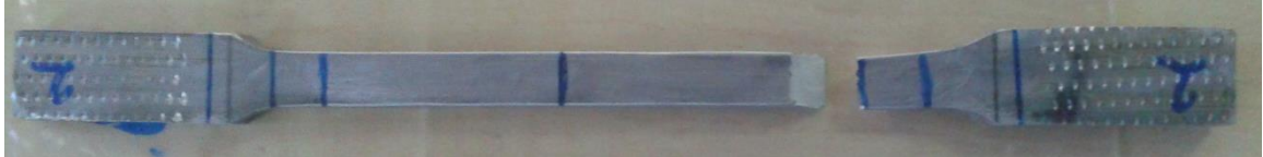
Şekil 3.22 Çekme numunesinde çekme deneyi sonucunda elde edilen görüntüsü
