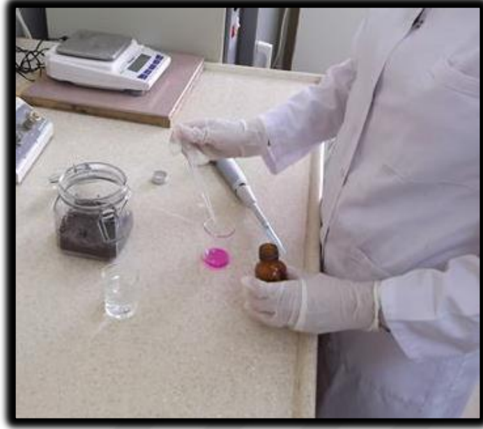
Şekil 3.7. Karbon mineralizasyonunda doymuş Ba(OH)_2 üzerine 2 damla fenolftalein ekleme aşaması
