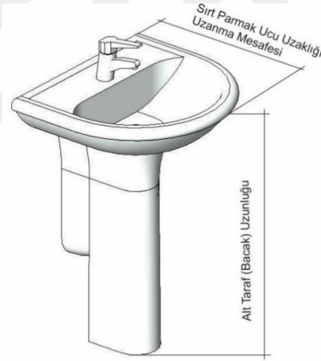
Şekil 16. Lavabo Tasarımında Kullanılması İçin Önerilen Bazı Antropometrik Ölçüler ( http://proje.dizini.net/resimler/sink_91931.jpg )
