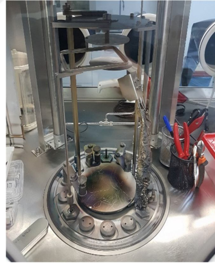
Şekil 3.8. Termal buharlaştırma sisteminin şematik gösterimi ve Glovebox içerisinde Termal PVD sistemi.
