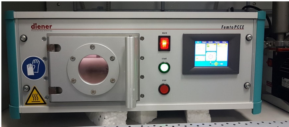
Şekil 3.3. TCO yüzeylerin hazırlanmasında kullanılan O 2 plazma sistemi.
