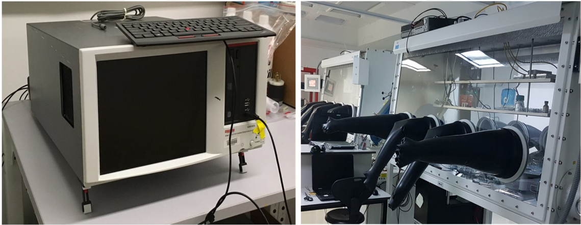
Şekil 3.9. Elektriksel ölçümlerinin yapıldığı glovebox sistemi ve Keithley 4200 SCS parametre analizörü.
