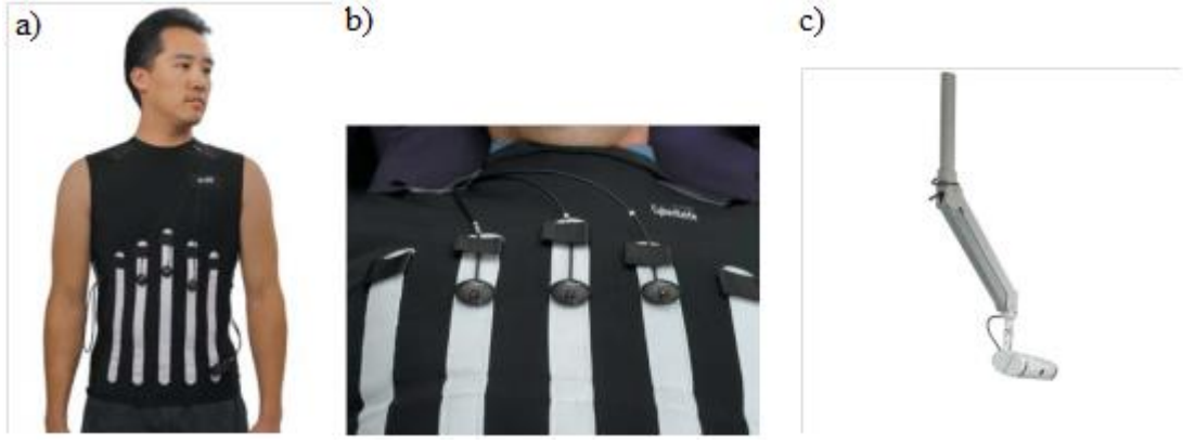
Şekil 2.18. a) Özel tasarlanmış yelek b) fiber optik işaretleyiciler c) solunum hareketini gerçek zamanlı izleyen kamera.
