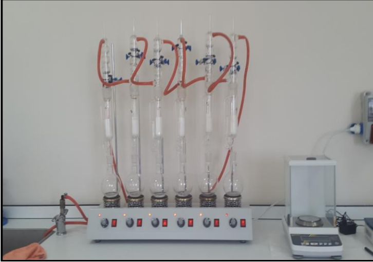
Şekil 3.14. Yağ-gres analizi düzeneği
