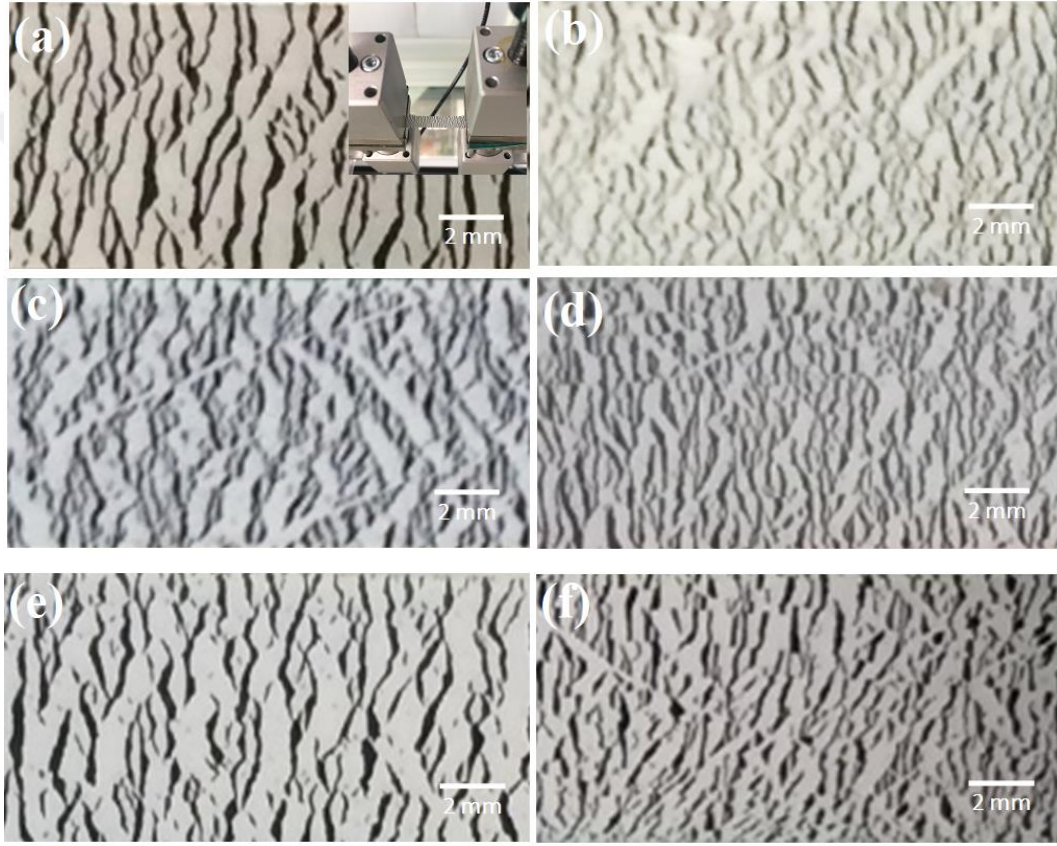
Şekil 4.23. %300 çekilmiş (a) P-50, (b) SLG/P-50, (c) E-50, (d) SLG/E-50, (e) M-50 ve (f) SLG/M-50 filmlerinin parafim/Au alttaş üzerindeki kırılma davranışları
