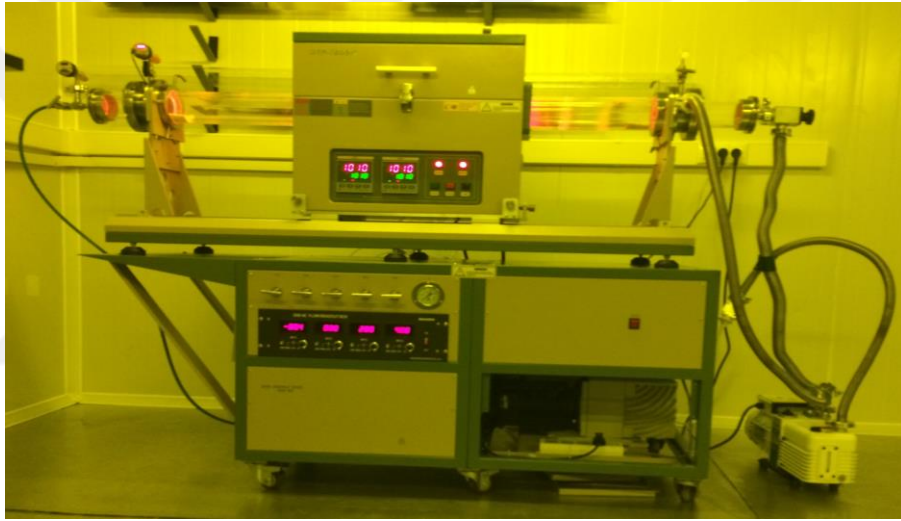
Şekil 3.3. SLG yapısının biriktirildiği CVD cihazının görüntüsü
