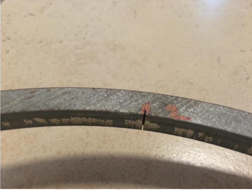
Şekil 5.5 : Bu çalışmadaki deneyde kullanılan çatlak.
