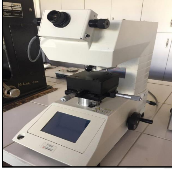
Şekil 4.1. Sertlik ölçümünde kullanılan Shimadzu marka sertlik cihazı.
