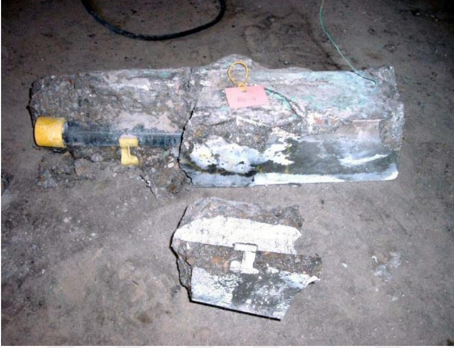
Şekil 4.22 : Sökülen kayma demirlerinin gözle muayenesi [33].
