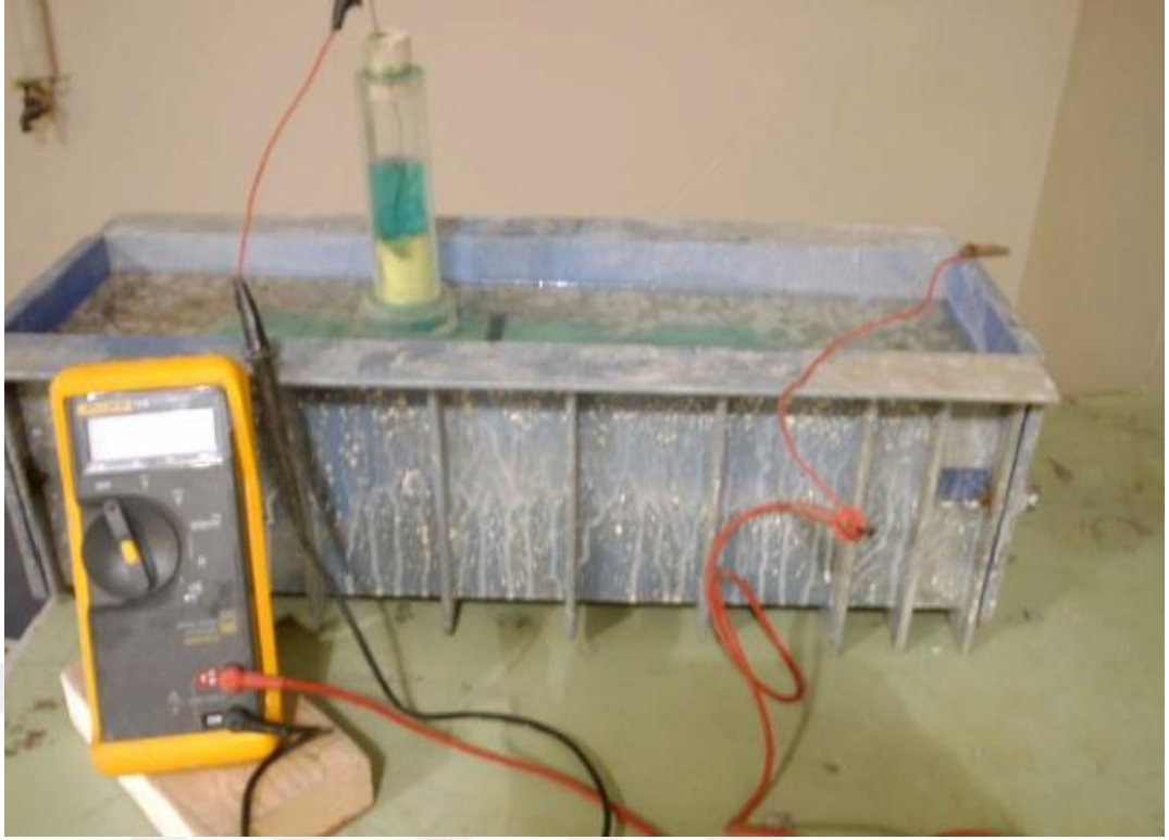
Şekil 4.4 : Yarı hücre potansiyeli testi [33].
