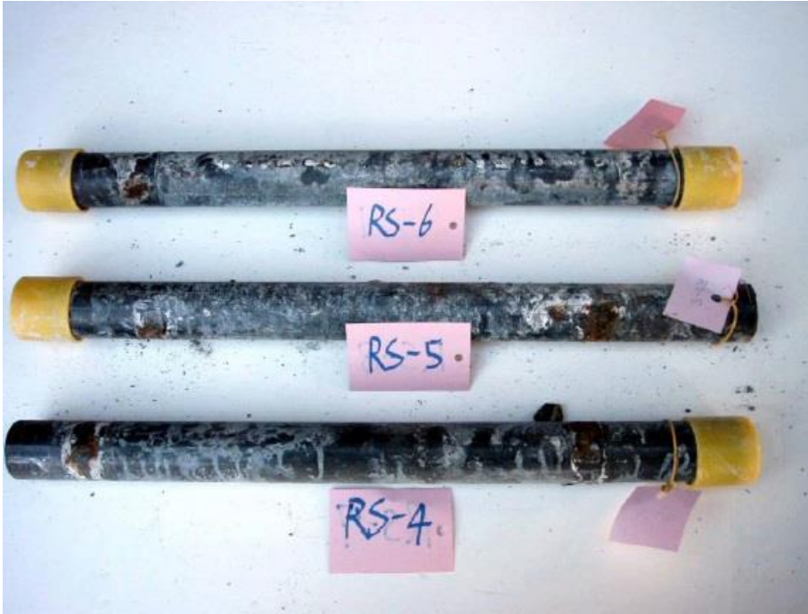
Şekil 4.23 : Karbon çelikleri boyunca oluşan korozyon [33].
