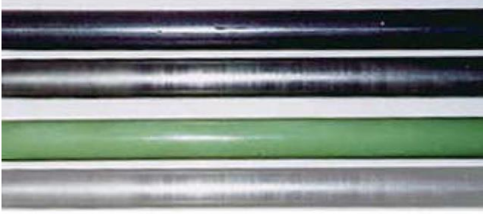
Şekil 4.2 : Aşama 1’de kullanılan kayma demiri çeşitleri. Yukarıdan aşağıya: karbon çeliği, paslanmaz kaplı çelik, esnek epoksi ile kaplı çelik ve harç dolu delikli paslanmaz çelik [33].
