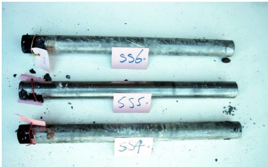
Şekil 4.25 : Delikli paslanmaz çeliklerin testten sonraki görünüşü [33].
