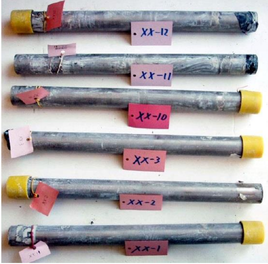
Şekil 4.26 : Paslanmaz kaplı çeliklerin testten sonraki görünüşü [33].
