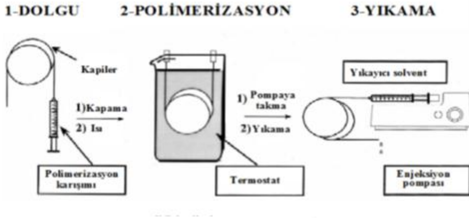
Şekil 2.13. Monolitik kolon hazırlanma süreci [205].
