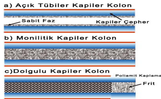
Şekil 2.11. CEC'de kullanılan kolonlar: a) Açık-Tübüler Kolon(OT) b) Monolitik kolonlar c) Dolgulu Kolonlar [179].
