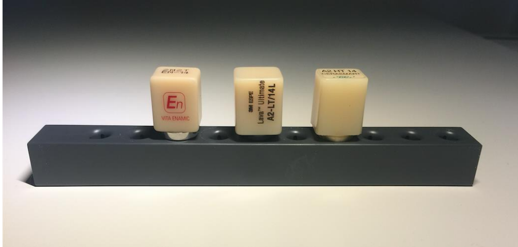
Şekil 3.1. Enamic, Lava Ultimate ve GC Cerasmart bloklar.
