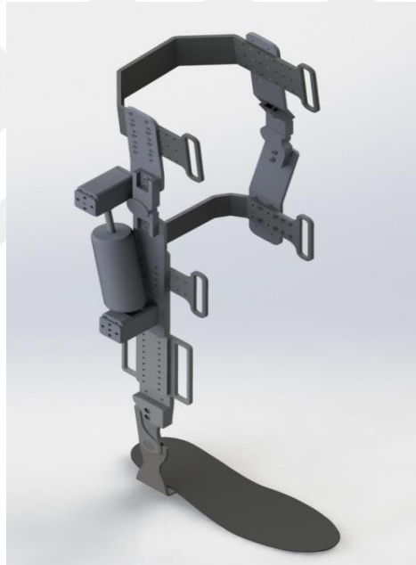
Şekil 4.8 Diz ortezi mekanik modeli
