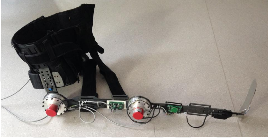
Şekil 4.4 Dış iskelet mekaniği
