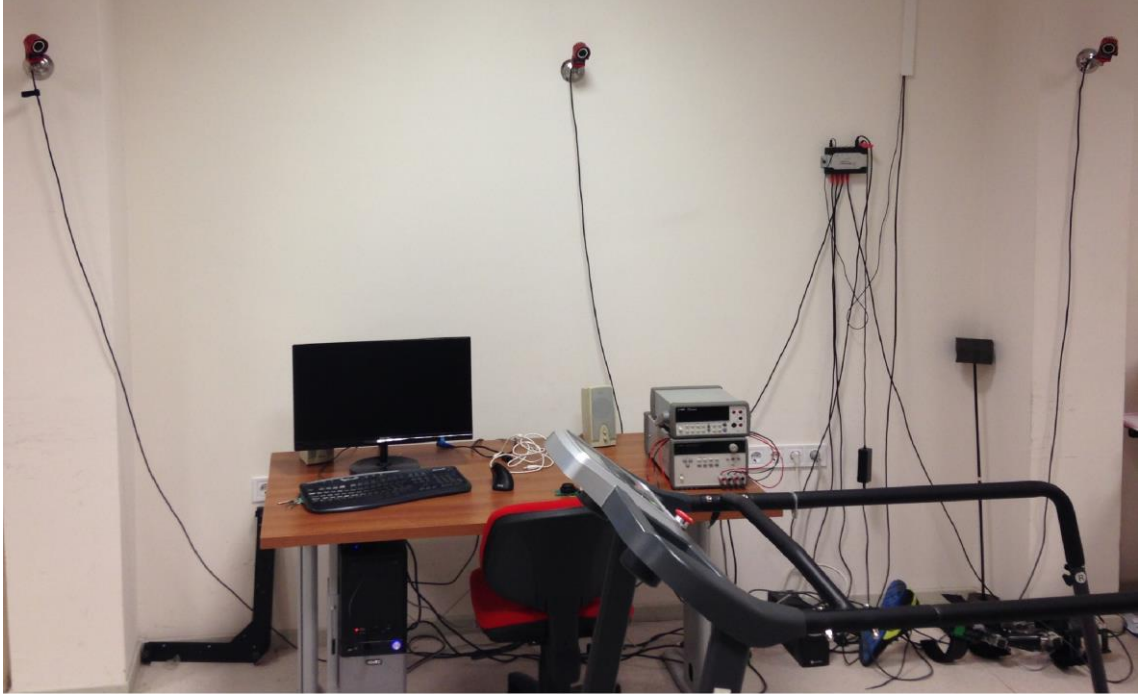
Şekil 3.7 Optitrack kamera tabanlı hareket ölçüm sistemi
