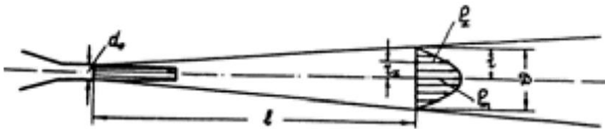
Şekil 1.2 : Su jetinin nozulden çıktıktan sonraki basınç profili [5].
