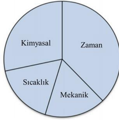
Şekil 1.1 : Temizleme performansını etkileyen parametreler [3].
