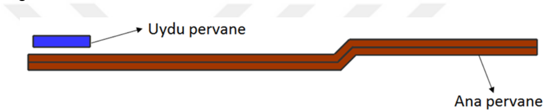
Şekil 3.11 : Ana pervanesinin kademeli hale getirilmiş hali.
