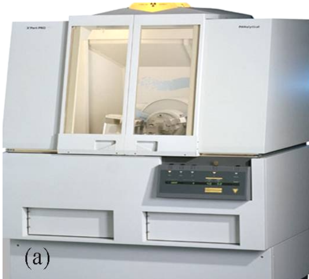
Şekil 3.4. Philips X`Pert PRO marka XRD cihazının (a) dış ve (b) iç görünümü
