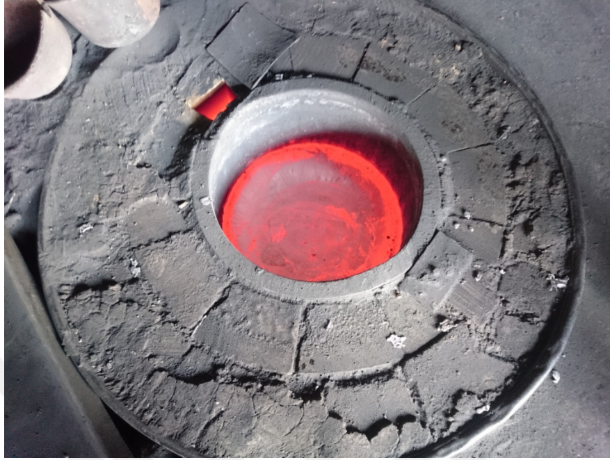
Şekil 3.7. Ergitme İşleminin Yapıldığı Yer Ocağı
