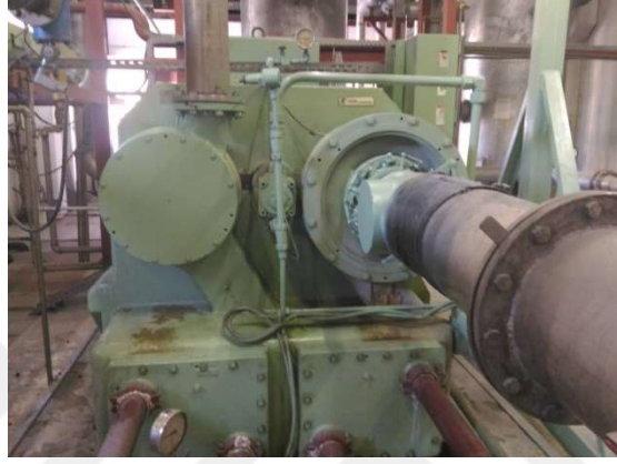
řekil 6.11. Revizyon öncesi TA-48 turbo kompresör airenđ ünitesi
