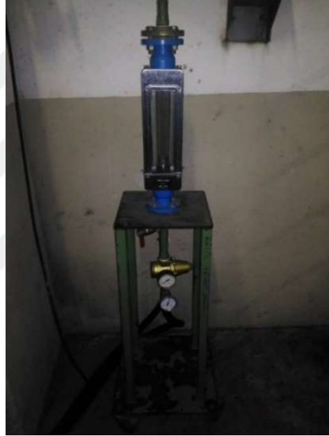
Şekil 6.14. Kaçak tespiti için makine girişine bağlanan seyyar debimetre
