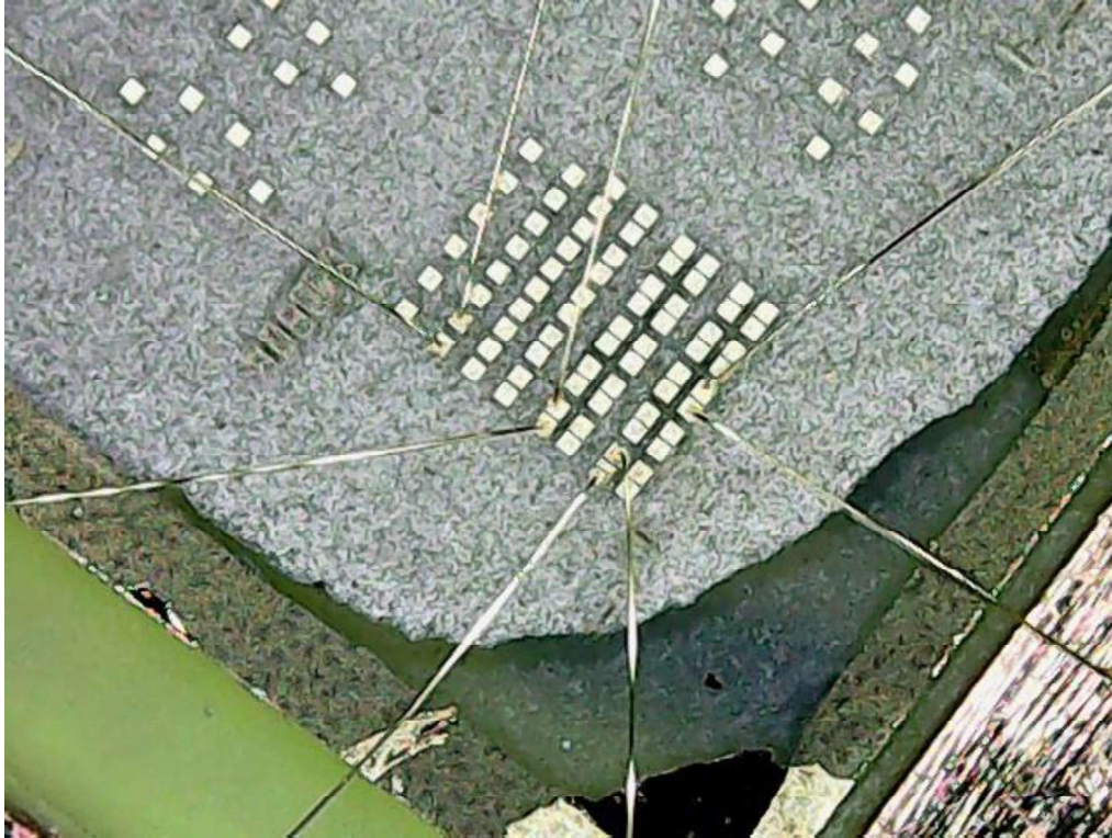
Resim 5.2. Nanosaniye atımlı I-V ölçümleri fabrikasyonu yapılan numunelerin basit bar geometrisinin fotoğrafı
