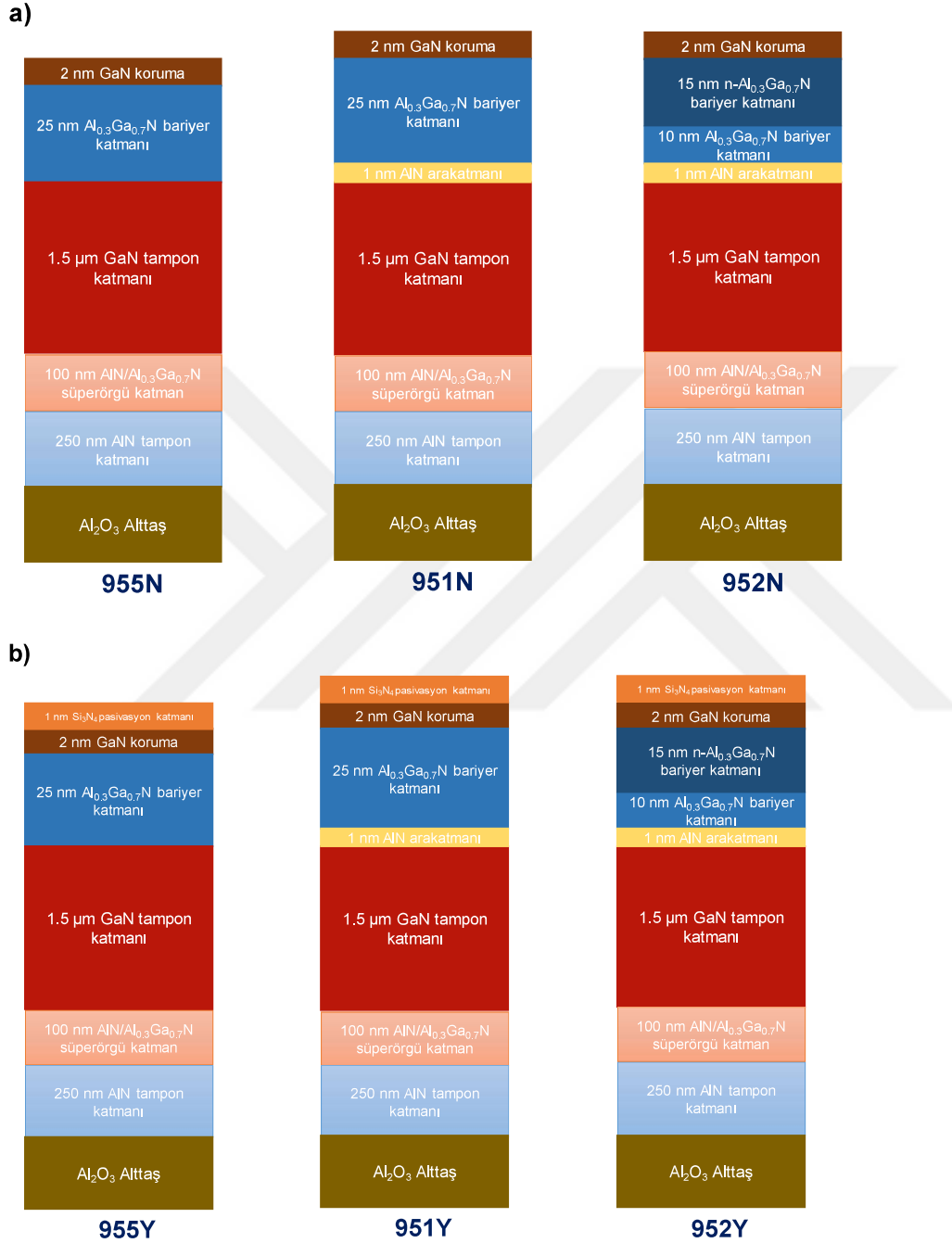
Şekil 5.1. (a) AlN arakatmanın olmadığı katkısız AlGaN/GaN çokluyapısı (955N), AlN arakatmanlı katkısız AlGaN/AlN/GaN çokluyapısı (951N) ve AlN arakatmanlı Si-katkılı AlGaN bariyerin olduğu n-AlGaN/AlGaN/AlN/GaN çokluyapısının (952N) pasivasyonsuz durumda katman kalınlık ve malzeme bilgileri. b) a)'da verilen numunelerin pasivasyon sonrası yapı yarı kesitleri
