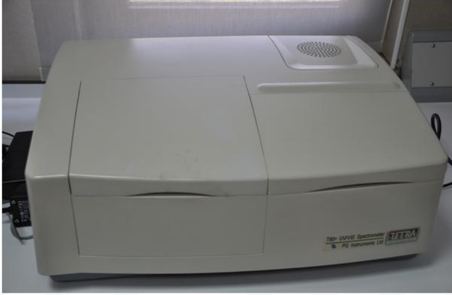
Resim 3.1. Spektroskopik analizlerde kullanılan UV/VIS spektrofotometre[120]
