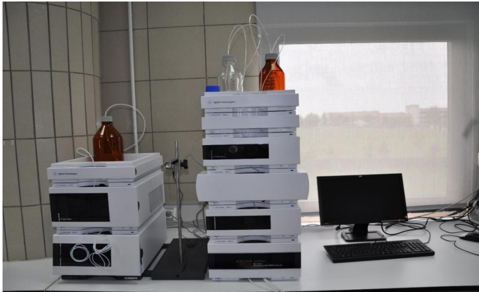
Resim 3.2. S.cerevisiae hücrelerinde bulunan spesifik karoten miktarlarının tayininde kullanılan HPLC cihazı [121]
