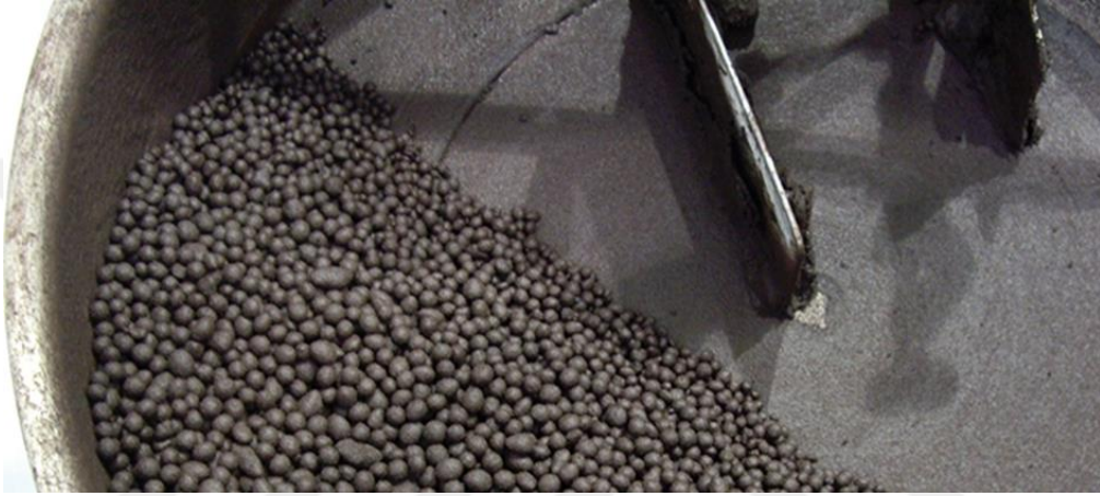
Şekil 4.3. Peletleme işleminde kullanılan disk ve üretilen peletler [19,22].
