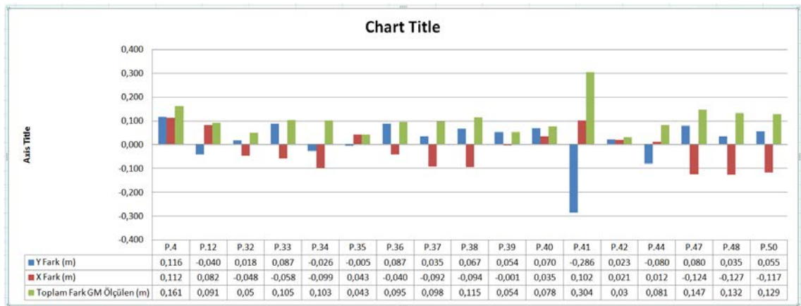
Şekil 4. 8 İHA Üzerindeki GPS ile Elde Edilen Yatay Koordinat Analizi
