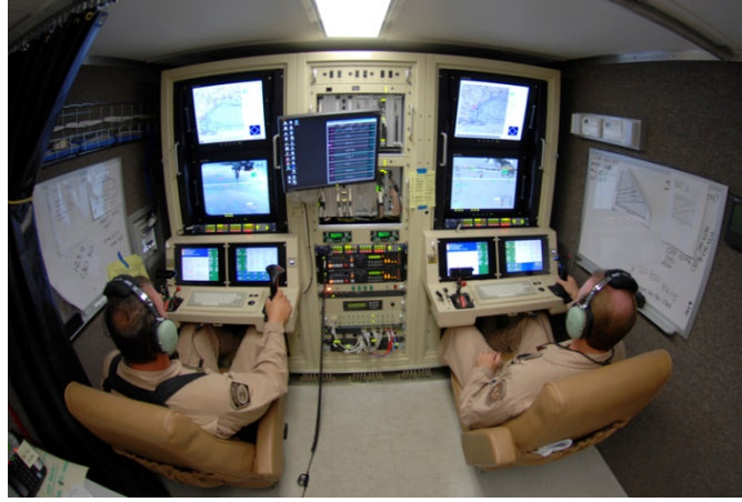
Şekil 2. 6 Bağımsız kontrol istasyonu
