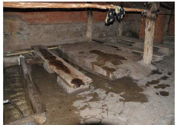
Şekil 3.70. Kayı Köyü-1 sakanasındaki beton ile yükseltilmiş üç adet ahşap dövme taşı ve bir büyük beton yüzey.
