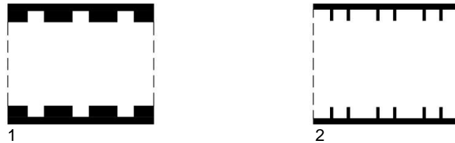
Şekil 4.16. Ocaklar karşılıklı iki duvar üzerinde olduğunda, ocakların duvarla olan ilişkisi.
